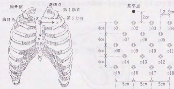
図6.1: 心臓磁場の測定系。平面 z=0 上の p01, p02, \dots, p18 において、直径 1.3\text{cm} 、ベースライン 8.0\text{cm} の1次微分コイル(巻き数2)で法線方向の磁場( z 成分)が測定された。
