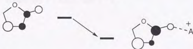
Figure 68: アクセプターによる LUMO の係数変化とエネルギー低下
