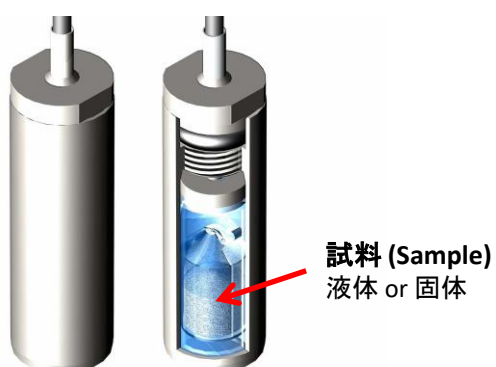
図 3-2 B. braunii の藻体スラリーの熱分析に用いた \mu DSC-7 用 Hastelloy 製セル [7] 改変
