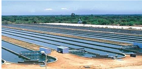
図 1-5 Parry Nutraceutical 社(インド)の Spirulina 生産に使用されているレースウェイ方式 [22]
