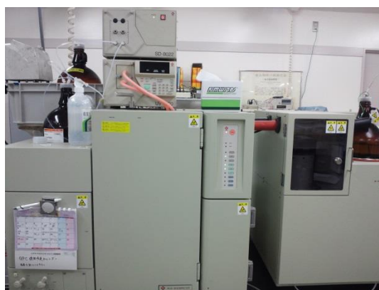
図 2-8 熱水抽出される多糖類の分子量測定に用いた高温ゲル浸透クロマトグラフ
