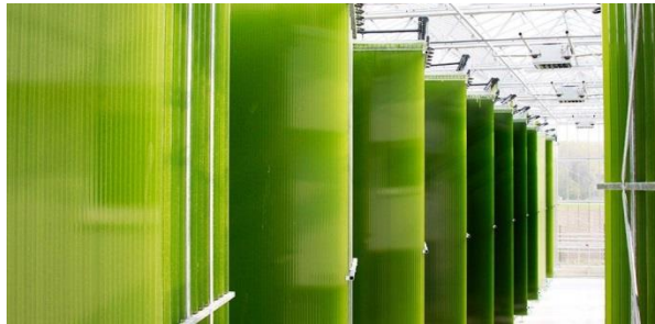
図 1-6 Ecoduna 社(オーストラリア)のフォトバイオリアクターPBR [23]
