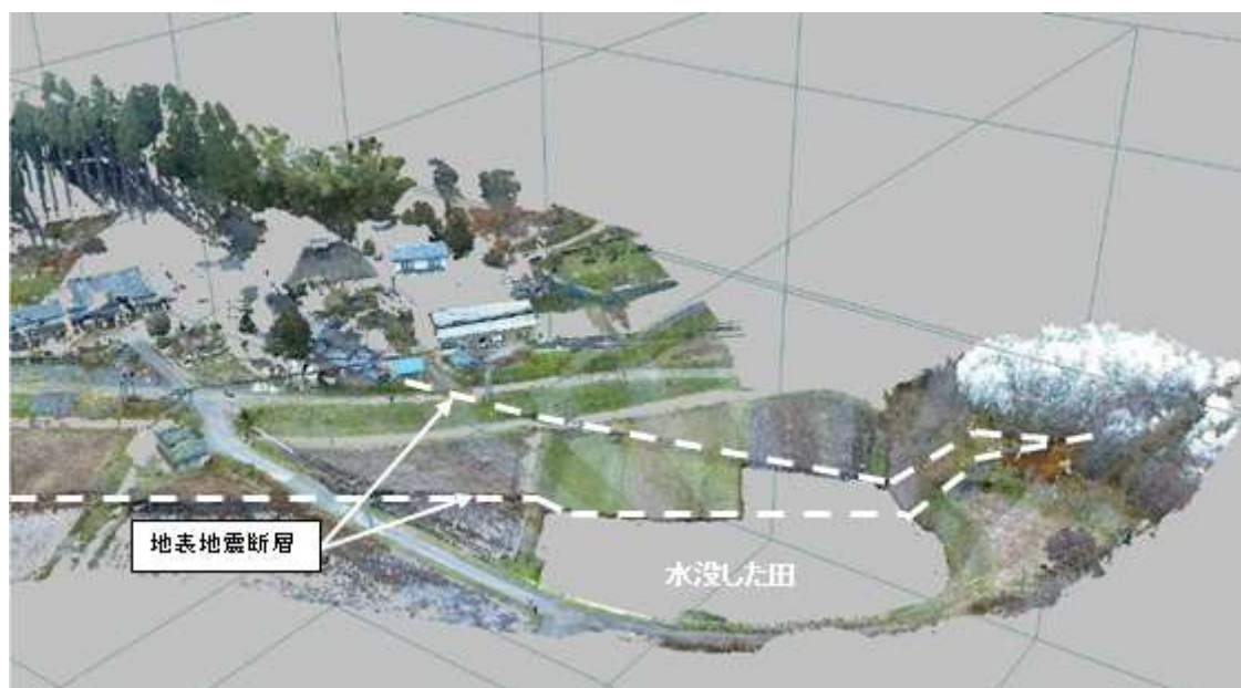
図 3.1.3 レーザスキャナーによる3次元イメージ (塩ノ平北方地区南部)
