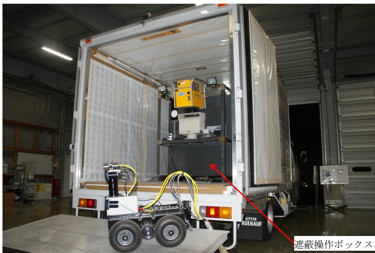
図 4-4 改装整備中のロボット操作車 RC-1 と偵察用ロボット JAEA-2 号
