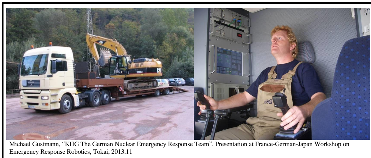
図 5 Excavator の専用トレーラと専用トレーラ内の遠隔操作機器
