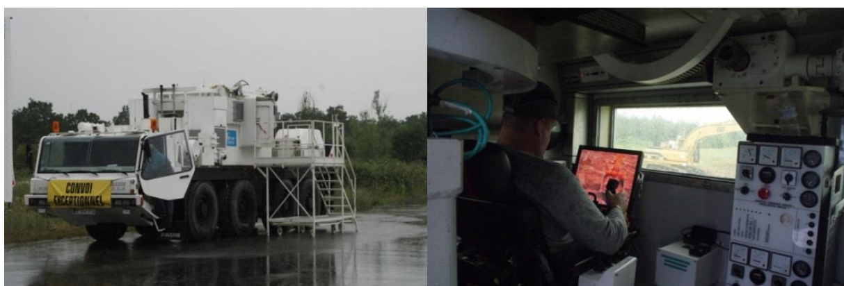
図 2-10 遮蔽を施したロボット操作車 EPPB と無人重機を操作するオペレータ
