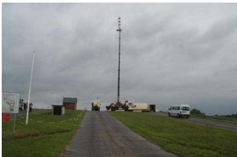
図 2-9 33 m マストの先端に取り付けられた遠距離通信用無線アンテナ
