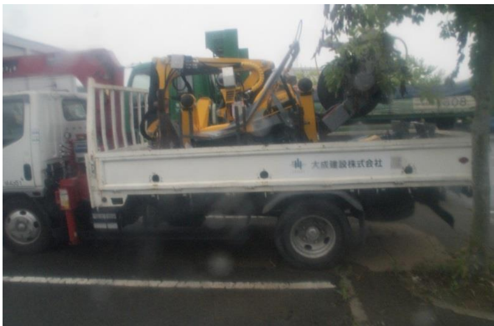
図 7-5 福島第一原子力発電所内で除染を待つ Brokk-90
