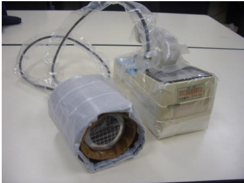
図 7-9 鉛シートを巻きつけた GM 管型放射線計測器
