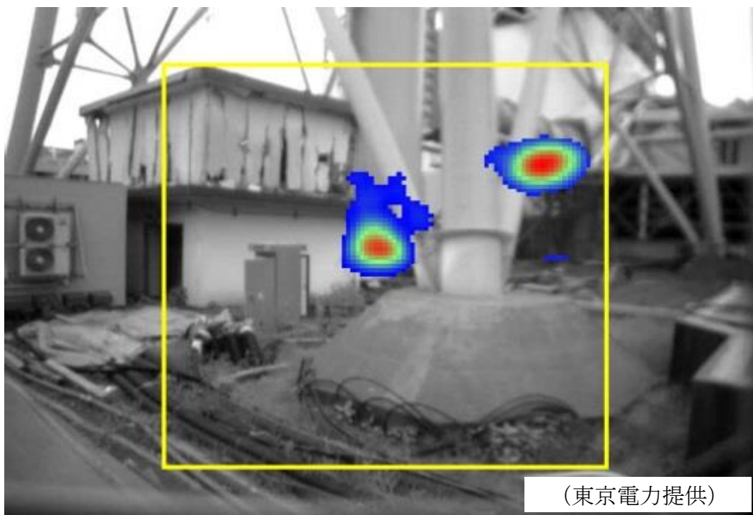
図 4-14 福島第一原子力発電所 1, 2号機共用排気塔付近の高線量部位
