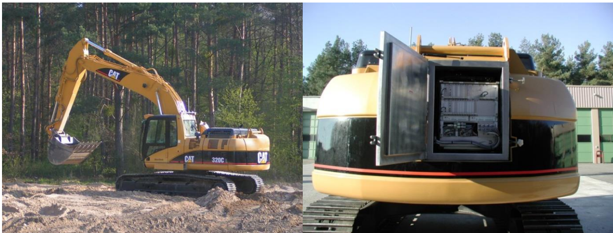
図 2-14 Excavator と電子回路用鉛遮蔽箱
