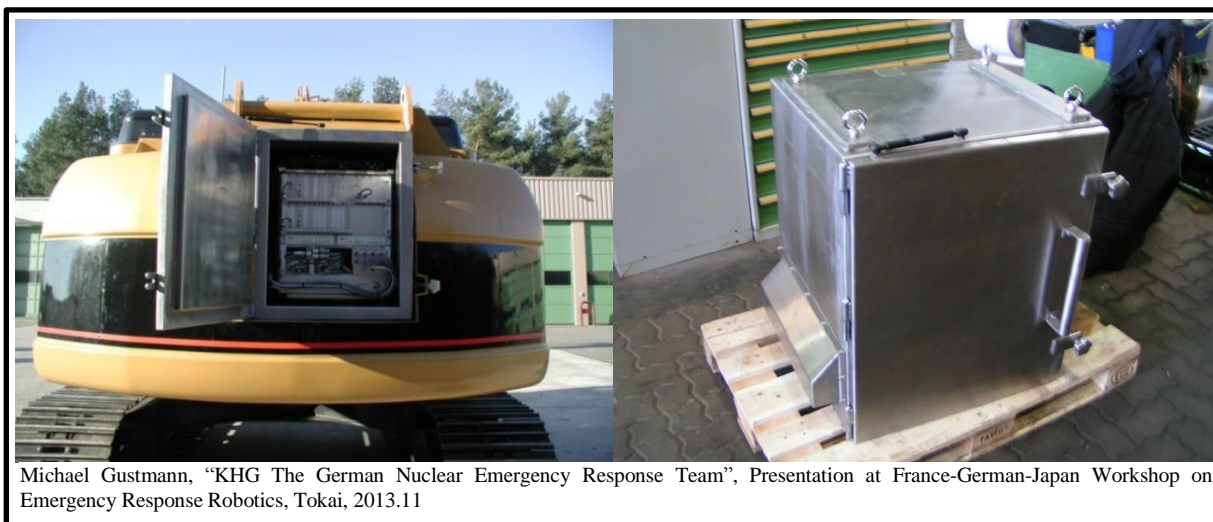
図 7 Excavator に搭載された電子回路用遮蔽 BOX
