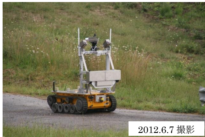
図 16 無線中継器を搭載した MTS
