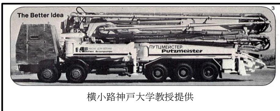
図 28 運転席に鉛遮蔽を施したコンクリートポンプ車
