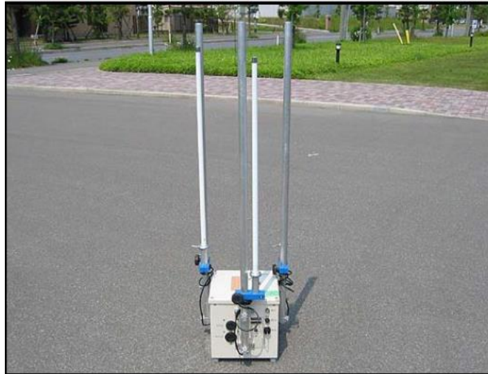
図 2-11 モニロボ用無線中継器
