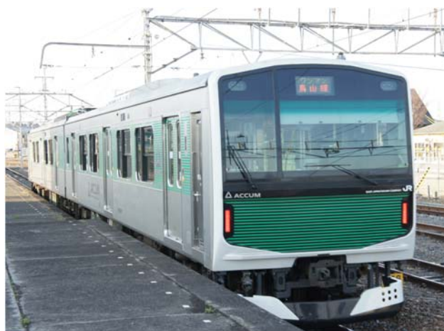
図 1. 4. 烏山線で運用中の蓄電池電車
