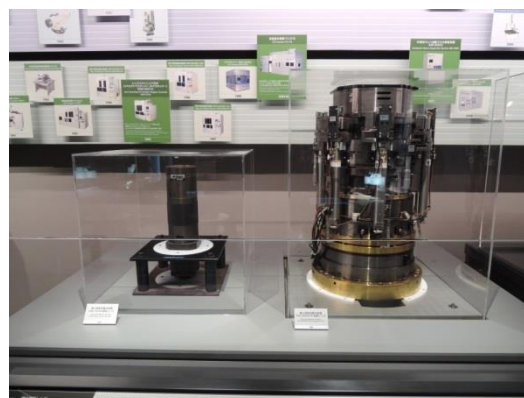
図 2.3; NSR-1505G (NA 0.30) (左) と NSR-2205EX14C (NA0.60) (右) の投影レンズ
