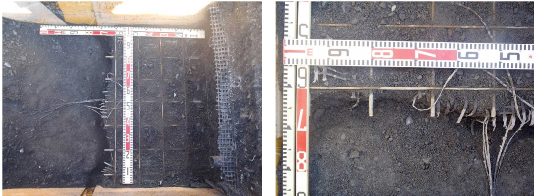
図 4.2.10 実験終了後に補強盛土に生じた亀裂（6層目底面）
