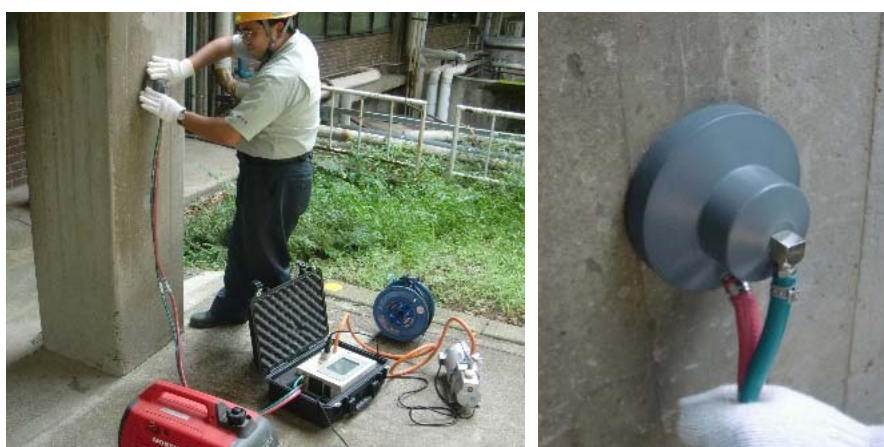
図 2.2.2 トレント法による表層透気試験の測定風景
