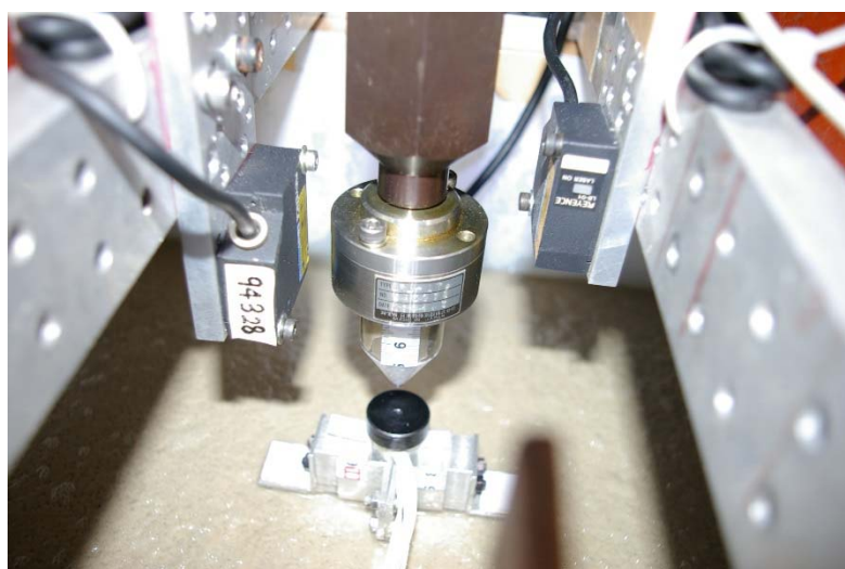
写真 2.2.11 杭頭部の加力計測状況 (1g)
