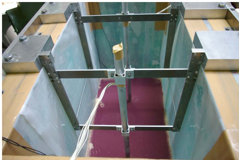
写真 2.2.5 模型杭設置状況
