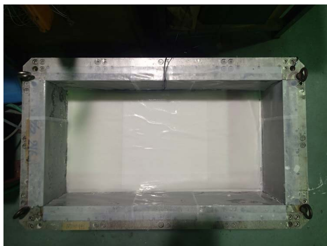
写真 3.2.3 粘土スラリー打設状況
