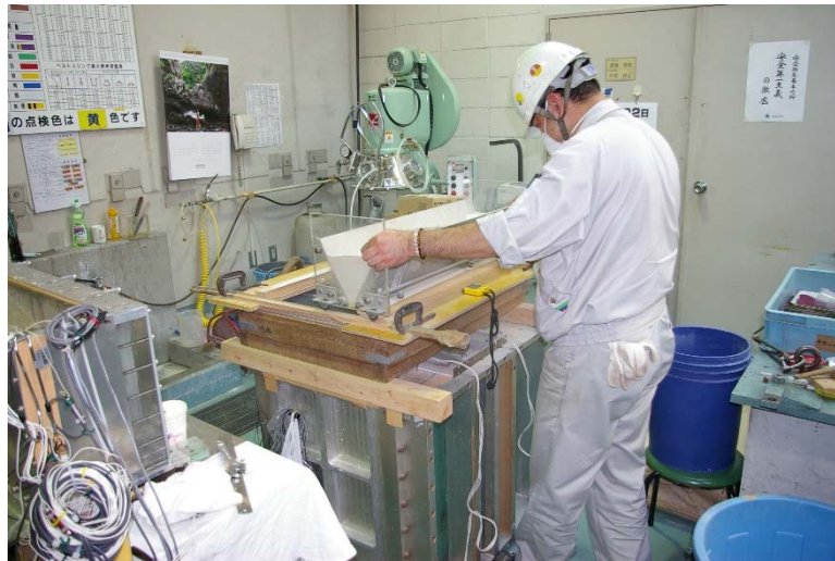
写真 2.2.4 空中落下法による砂地盤製作状況
