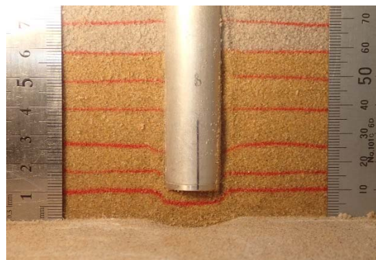
(d) 杭先端付近の地盤変状
