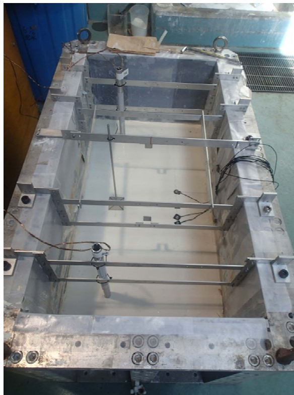
写真 3.2.5 杭設置状況 (Z4H0C8)
