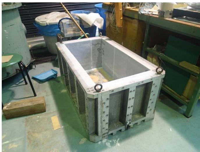
写真 3.2.1 使用した剛土槽
