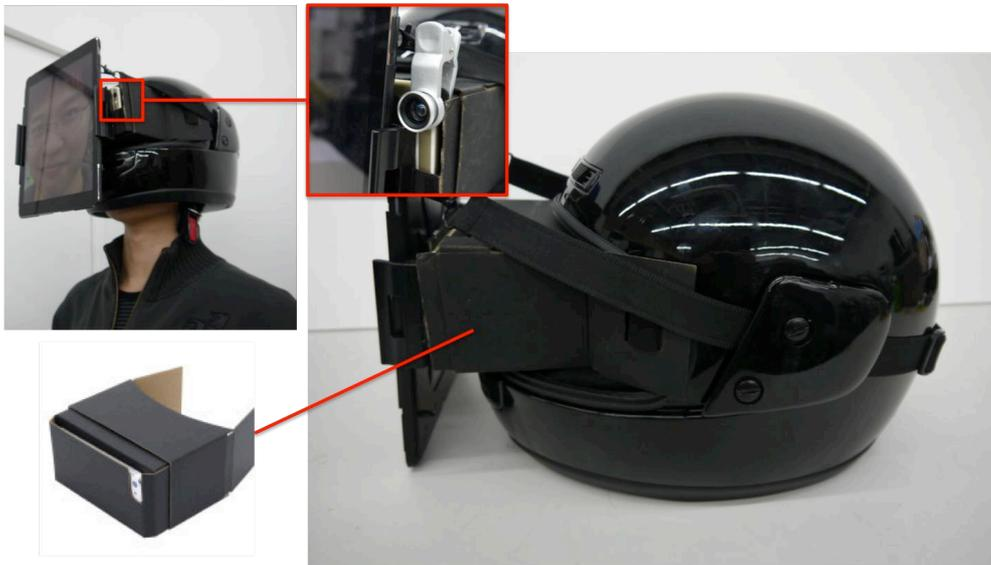
図 4.7: 初期の ChameleonMask : フルフェイスのヘルメットに段ボールの Hacosco がセットされている。
