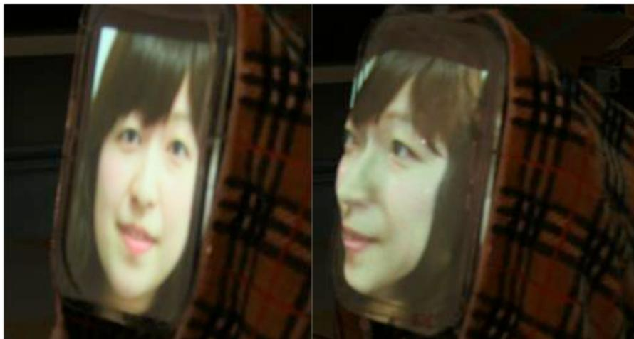
図 3.22: スクリーンの比較：2種類のスクリーンに同じ画像を投影している。左図が平面スクリーン、右図が顔スクリーン。
