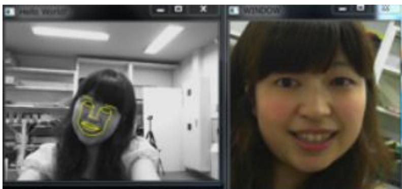
図 3.10: 顔画像の処理：顔認識が行われている時のスクリーンショットである。左図のように首を傾げた状態から画像補正後、右図に示す顔テクスチャが生成される。画像は投影用に反転される。
