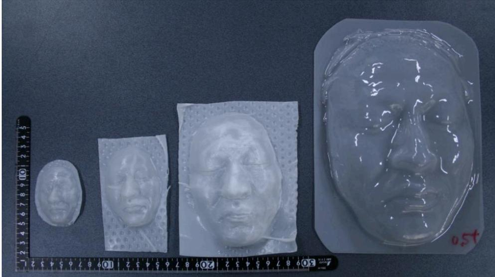
図 3.43: サイズの比較: 左は、1/14 スケールの顔型スクリーンである。右は実寸大の顔スクリーンである。
