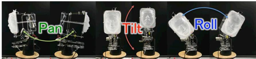
図 3.7: 頭部の三軸の動作 : パン-左右に首を振る動作、チルト-上下に頷く動作、ロール-左右に首を傾げる動作。
