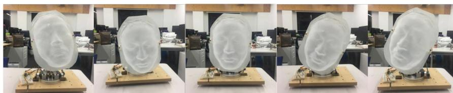
図 3.9: ロボット基盤を用いた頭部動作：3つのサーボモータによって駆動。
