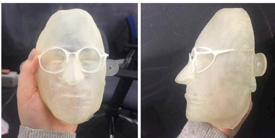
図 3.16: 眼鏡を 3 D プリンタで出力し接着させた顔スクリーン
