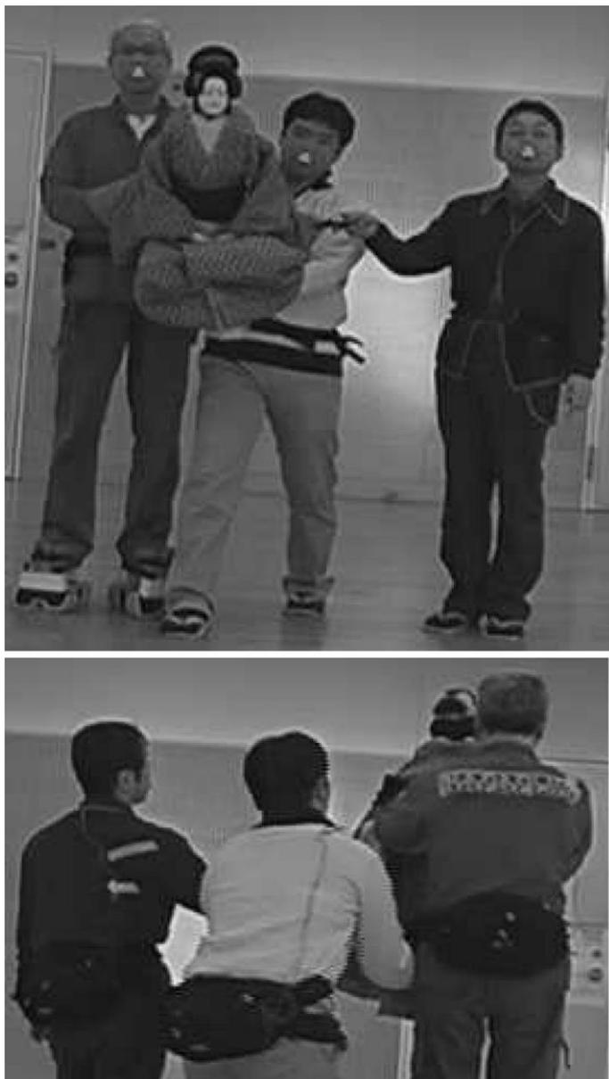
図 4 課題 1 における実験の様子。人形のかしらは「娘」である。上は正面。演者の鼻の下に呼吸センサーがついている。下は背面。演者の腰に見えるのは、生体計測アンプを入れたバッグである。
