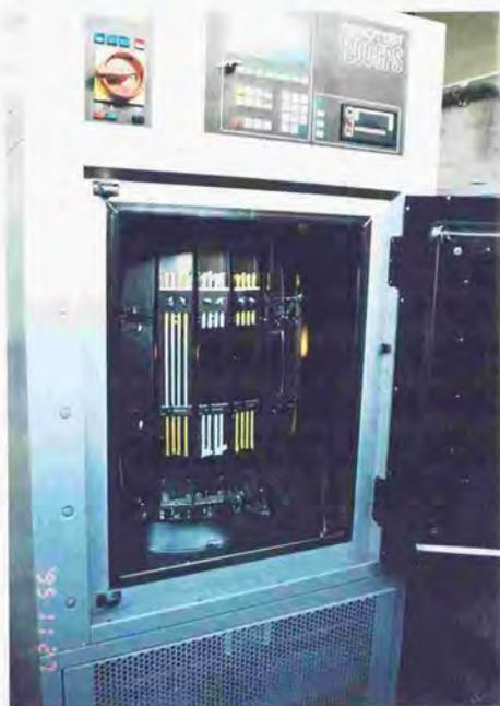
写真 3.3.1 紫外線照射試験装置 (FRP ロッド)
