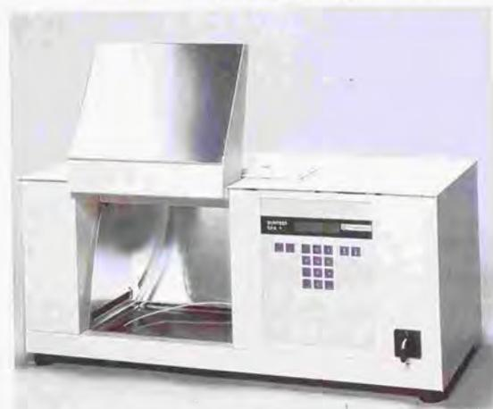
写真 3.3.2 紫外線照射試験装置 (繊維, マトリックス樹脂)
