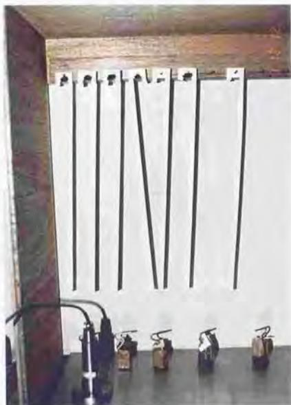
写真 3.4.2 繊維長 250mm のクリープ破断試験
