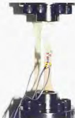
写真 3.2.8 マトリックス樹脂の試験状況
