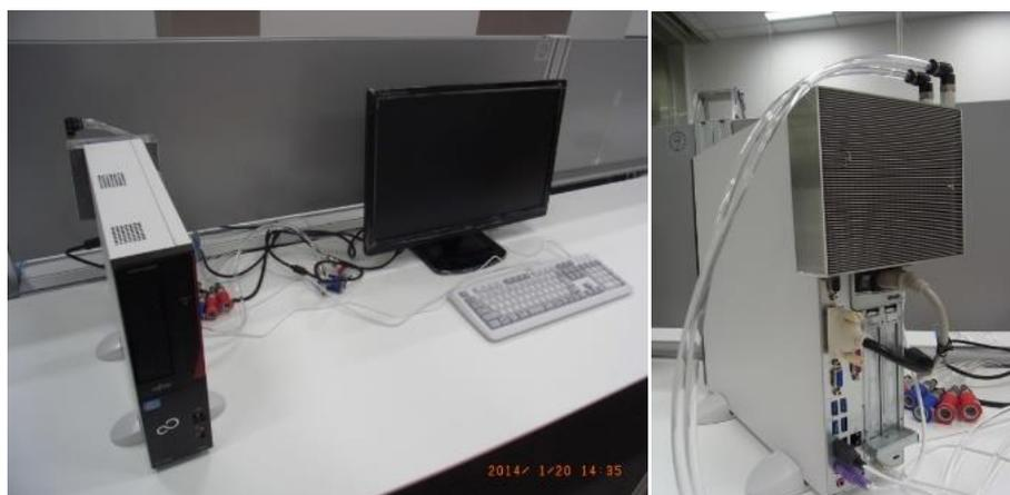
図5-5 液冷熱回収ユニットを付いているデスクトップパソコン<sup>[5-2]</sup>
