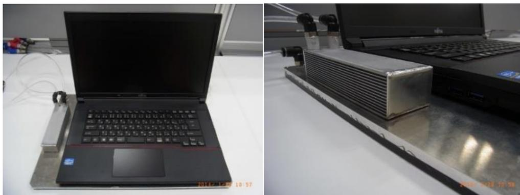
図5-4 液冷熱回収ユニットを付いているノートパソコン<sup>[5-6]</sup>
