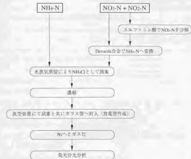
図3.4 発光分光分析法による \text{NH}_4\text{-N} 、 \text{NO}_2\text{-N} 、 \text{NO}_3\text{-N} の ^{15}\text{N} atom%分析手順
