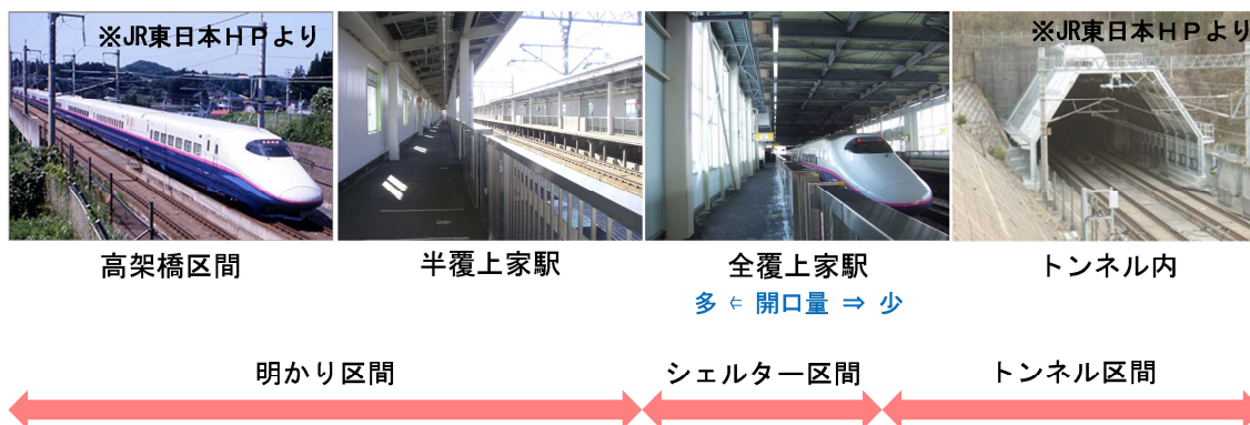
図 1-6 地上側の条件と列車通過時圧力変動波形の分類
