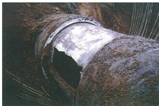
(b) 漏水事故後の PC 管破損状況
