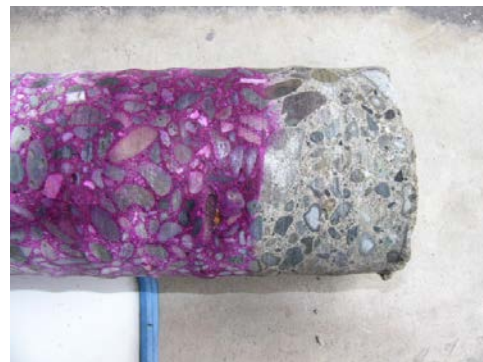
(d) 中性化試験後の呈色反応
