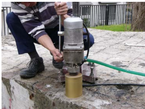
(c) コンクリート・コアの採取状況
