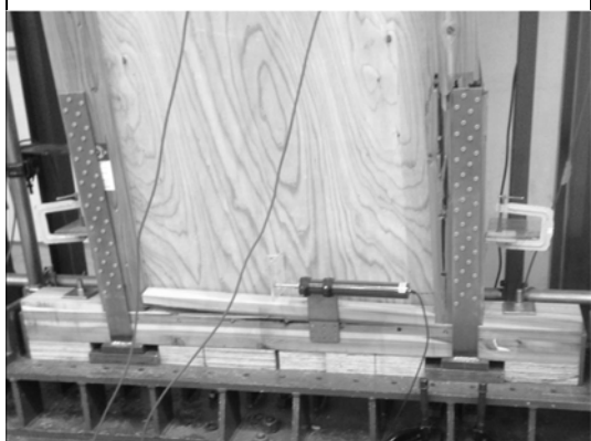
写真 2.2.43 壁脚 加力後
