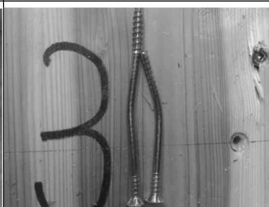
写真 2.3.87 ビスの変形と破断
