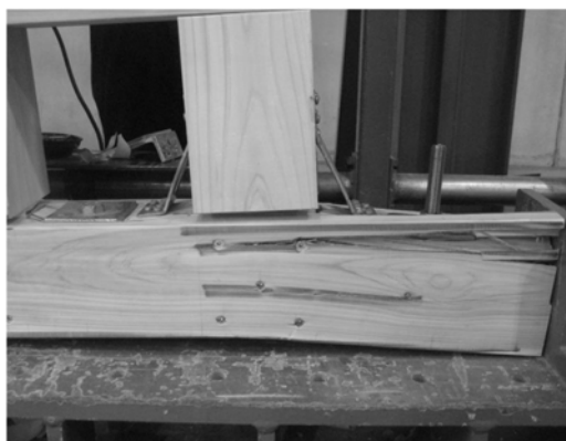
写真 3.3.11 KH-1 土台の割裂
