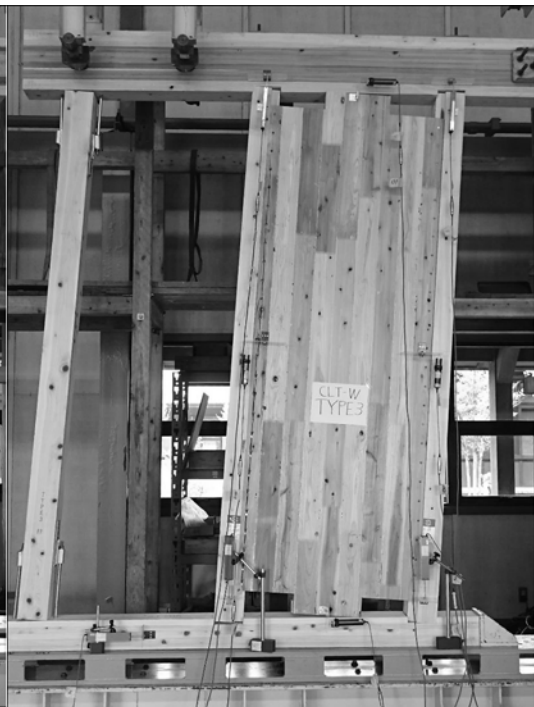
写真 2.3.22 試験体 CW-3 加力後
