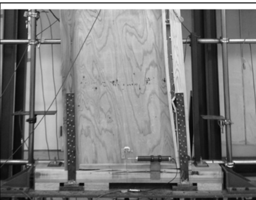
写真 2.2.30 壁脚 加力後
