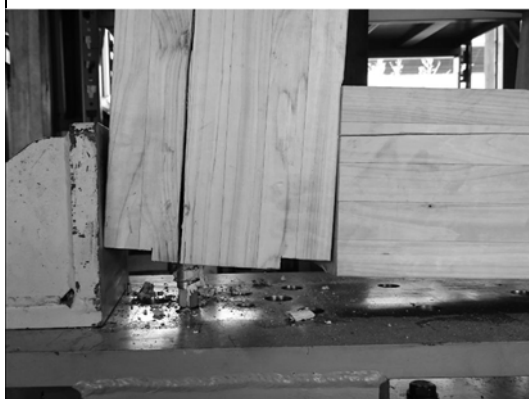
写真 2.3.73 CW-6 引張柱脚の破壊
