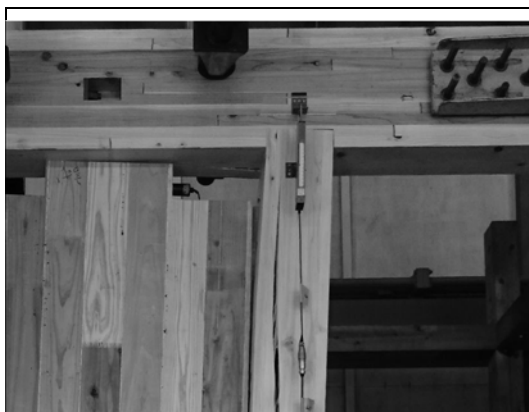
写真 2.3.77 CW-6 圧縮側柱頭 割裂
