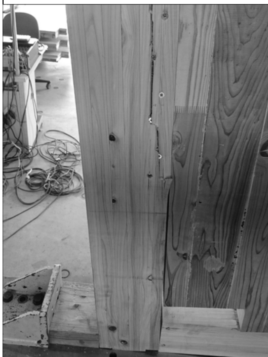
写真 2.3.79 圧縮側柱 ビス接合部
