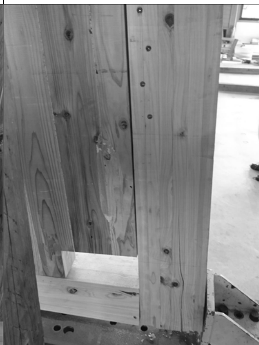
写真 2.3.80 引張側柱 ビス接合部
