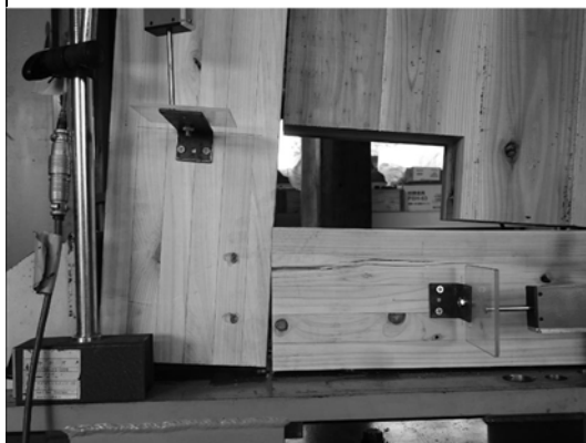
写真 2.3.44 CW-5-1 引張側柱柱脚
