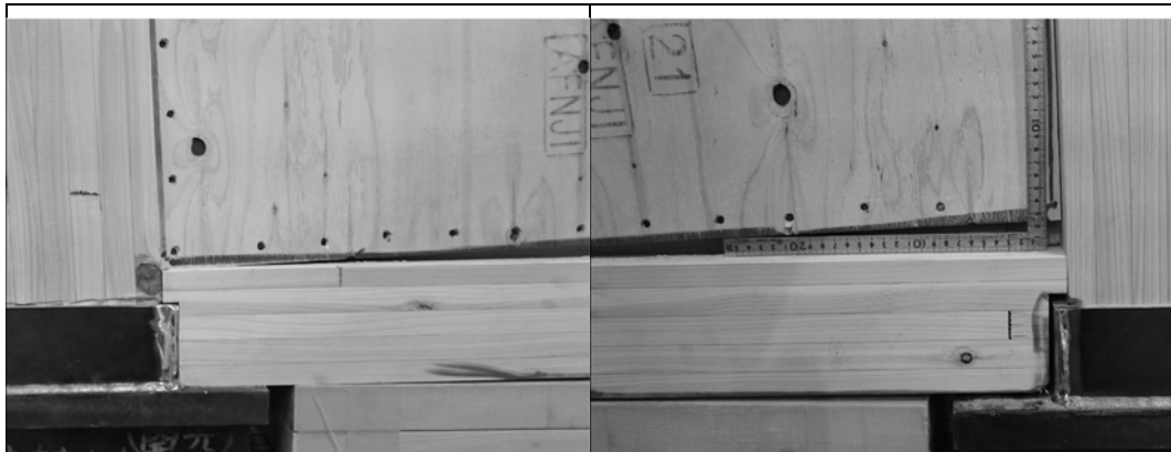
写真 2.4.6 PW-3-1 圧縮側柱脚
