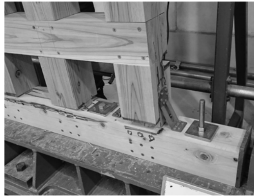
写真 3.3.22 KS-2 引張側柱脚
