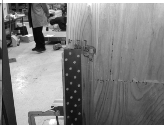
写真 2.2.46 柱引張破壊 背面
