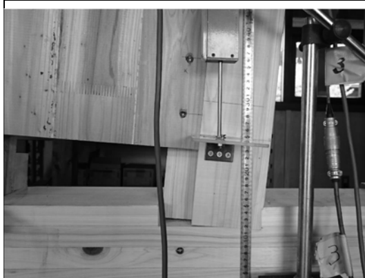
写真 2.3.25 圧縮側柱脚
