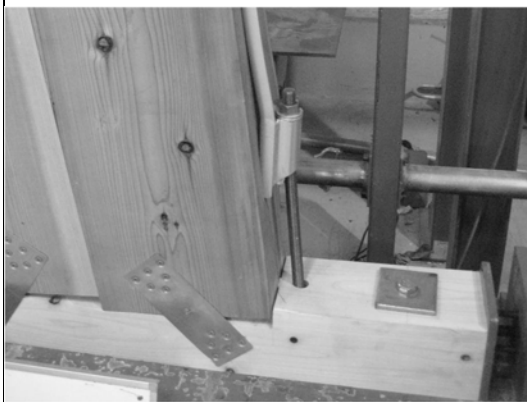
写真 3.2.37 MH-1 引張側柱脚 加力後
