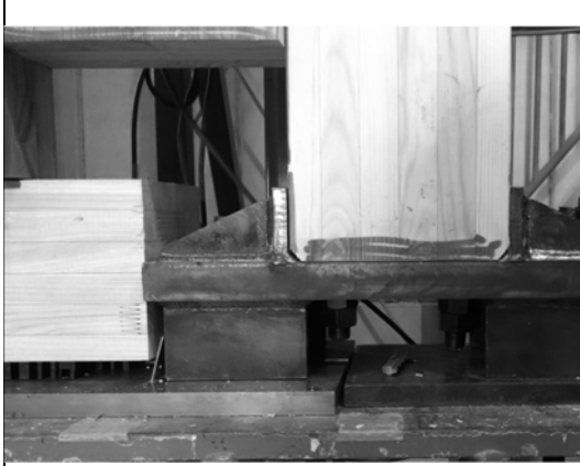
写真 2.3.102 CW-7-1 引張柱脚
