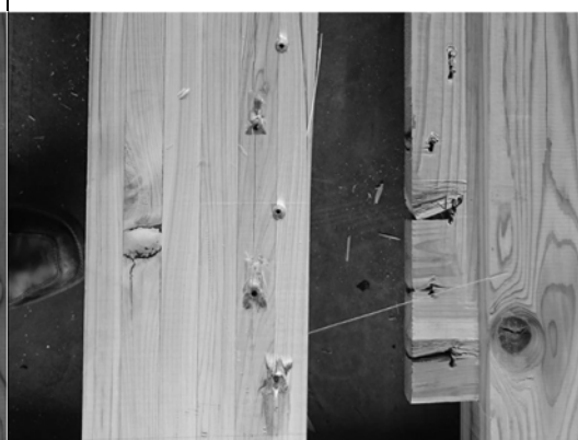
写真 2.3.61 CW-5-2 CLT の割裂
