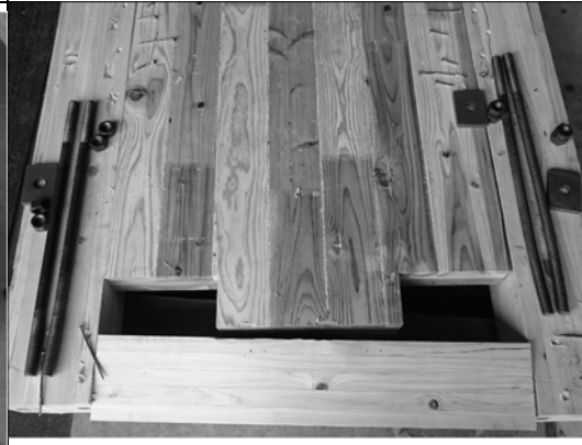
写真 2.3.53 CW-5-1 壁脚 加力後
