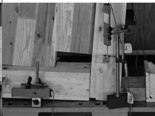
写真 2.3.74 CW-6 圧縮側柱脚
