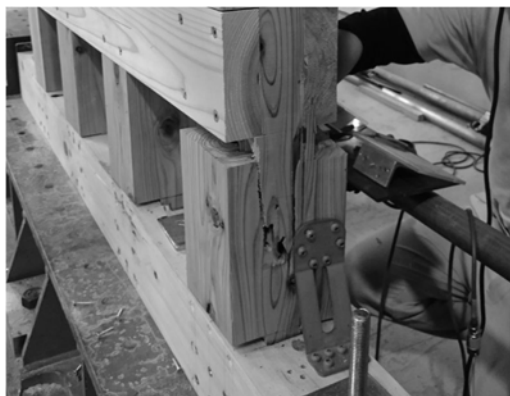
写真 3.3.30 KS-3 柱引張破壊 側面
