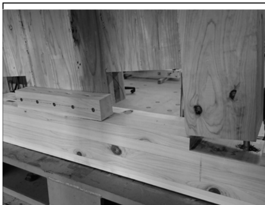
写真 2.3.5 壁脚（背面） 加力後
