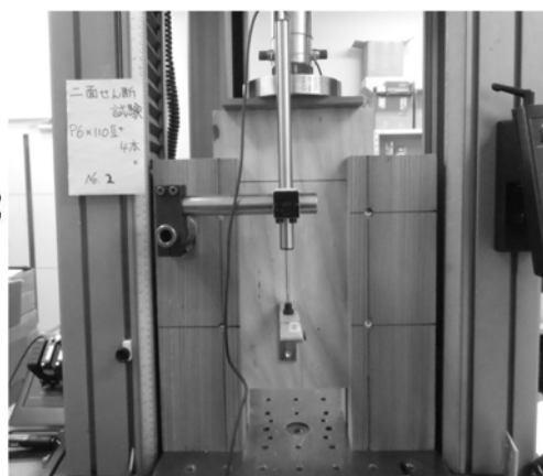
写真 2.2.1 ビス 2 面せん断試験試験体
