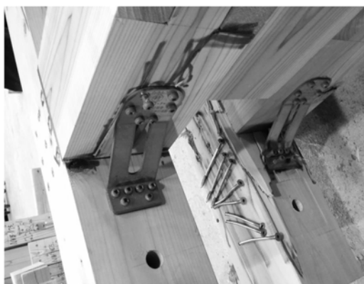
写真 3.3.15 KH-1 引張側柱脚 割裂
