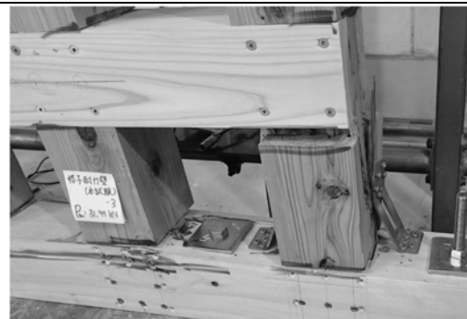
写真 3.3.29 KS-3 引張側柱脚 加力後
