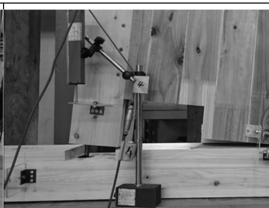
写真 2.3.6 引張側柱脚接合部
