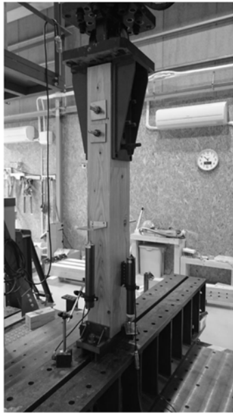
写真 4.2.1 柱脚試験写真
