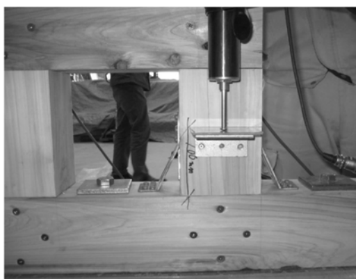
写真 3.3.17 KH-1 変位計の設置状況
