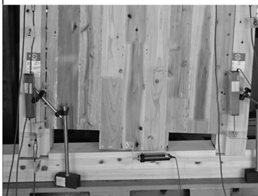
写真 2.3.23 壁脚 加力後
