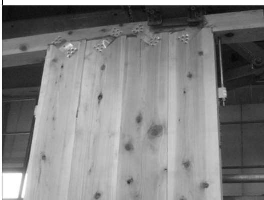
写真 3.2.46 MH-2 壁頭 加力後
