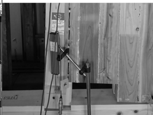
写真 2.3.24 引張側柱脚
