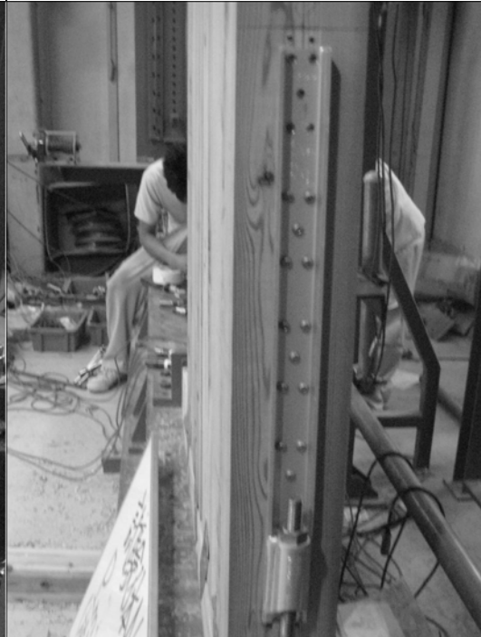
写真 3.2.55 MH-3 柱脚金物ビス 加力後
