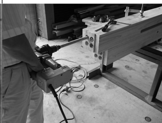
写真 2.3.82 CW-6 LSB の接合
