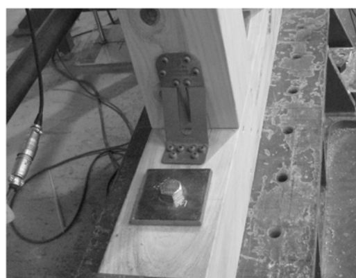
写真 3.3.10 KH-1 柱脚金物 (側面)
