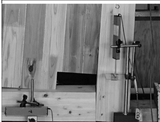
写真 2.3.58 CW-5-2 圧縮側柱脚
