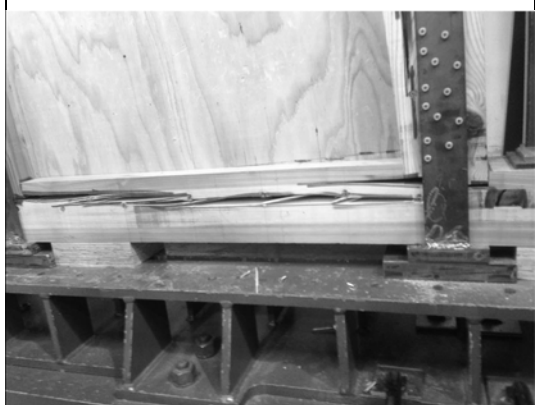
写真 2.2.33 土台の割裂
