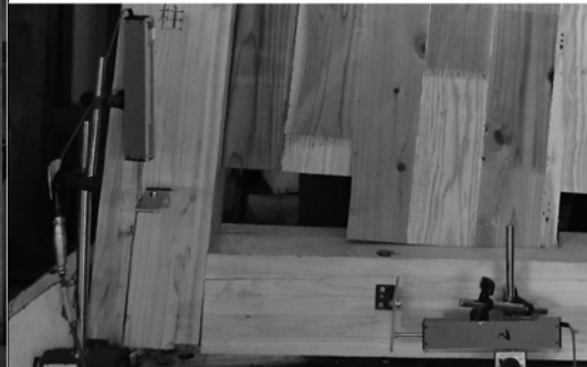
写真 2.3.72 CW-6 引張側柱脚
