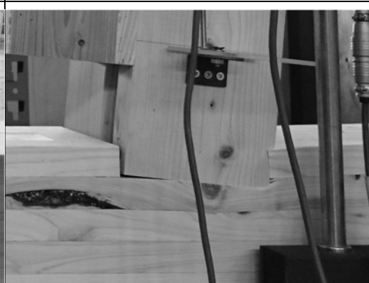
写真 2.3.8 圧縮側柱脚接合部
