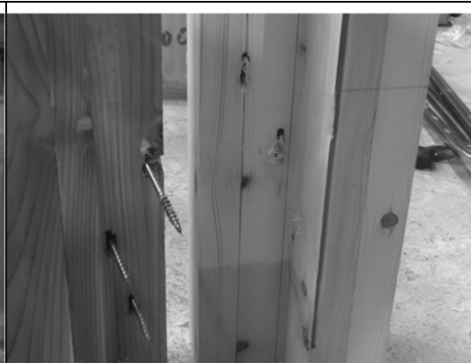
写真 2.3.85 ビスの変形 解体後
