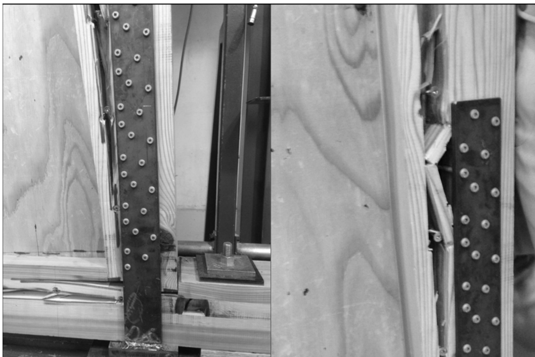
写真 2.2.37 柱脚割裂破壊
