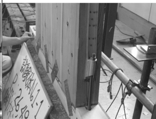
写真 3.2.36 MH-1 引張側柱脚 加力後
