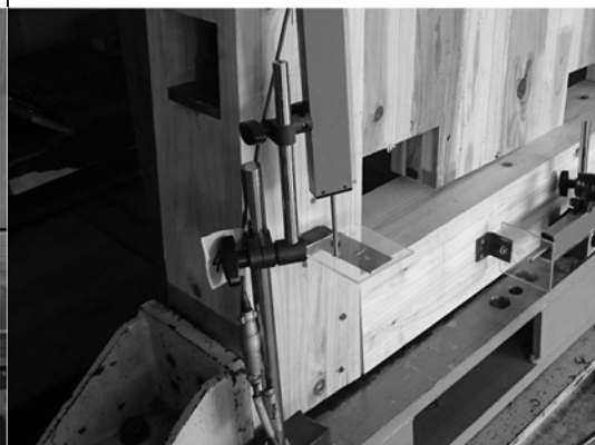
写真 2.3.45 CW-5-1 圧縮側柱柱脚
