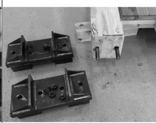
写真 2.3.103 CW-7-1 柱脚金物
