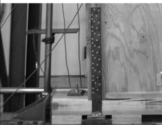
写真 2.2.32 圧縮側柱脚
