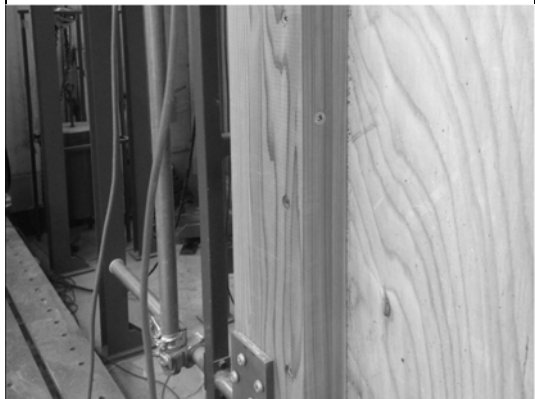
写真 2.2.41 割裂防止ビスの配置
