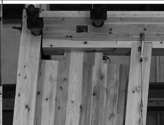
写真 2.3.59 CW-5-2 壁頭 加力後
