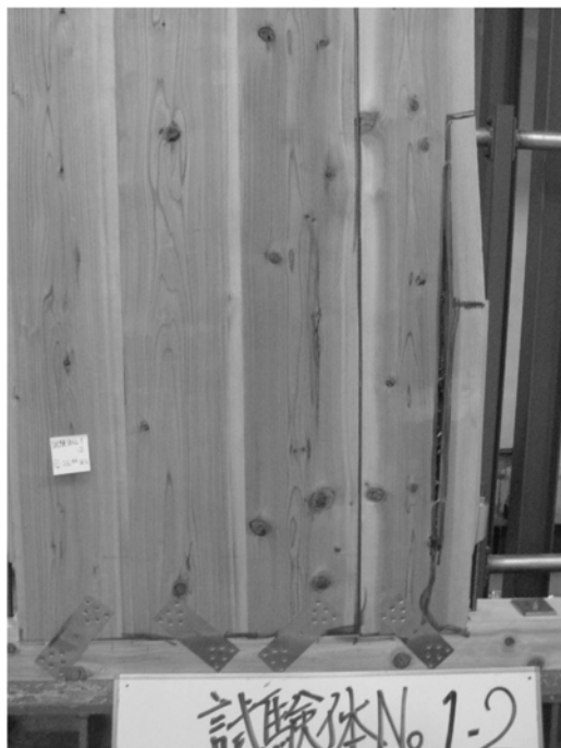
写真 3.2.42 MH-2 柱割裂破壊
