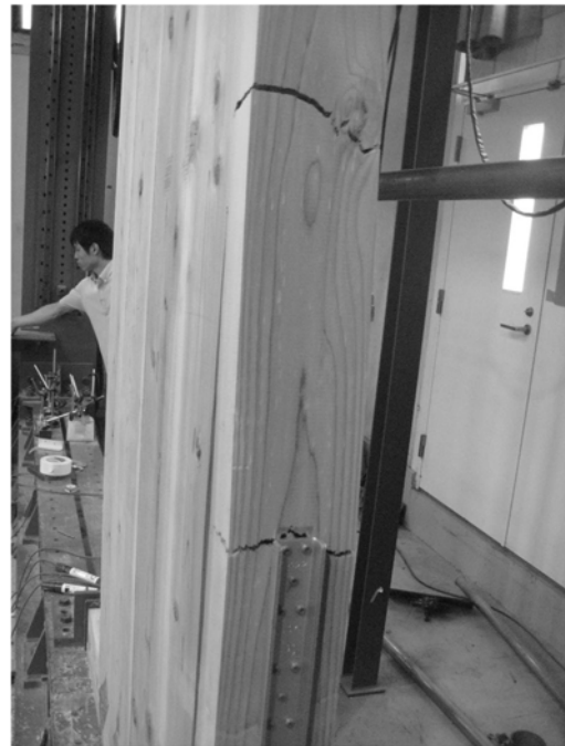
写真 3.2.43 MH-2 柱割裂破壊 側面
