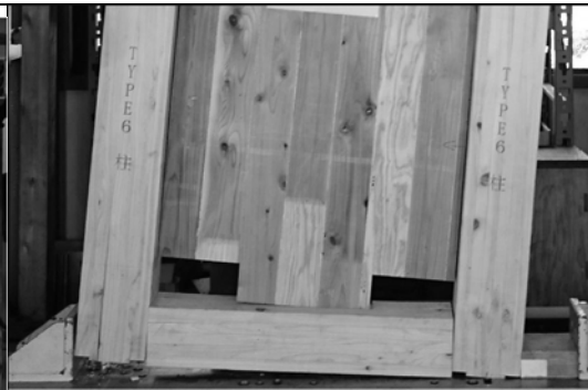
写真 2.3.71 CW-6 壁脚 加力後
