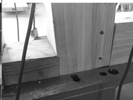
写真 2.3.47 CW-5-1 圧縮側柱柱脚
