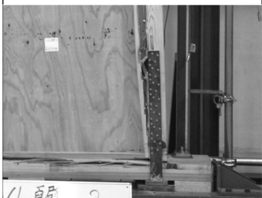
写真 2.2.31 引張側柱脚
