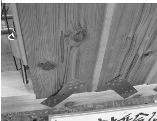
写真 3.2.52 MH-3 圧縮側柱脚 加力後
