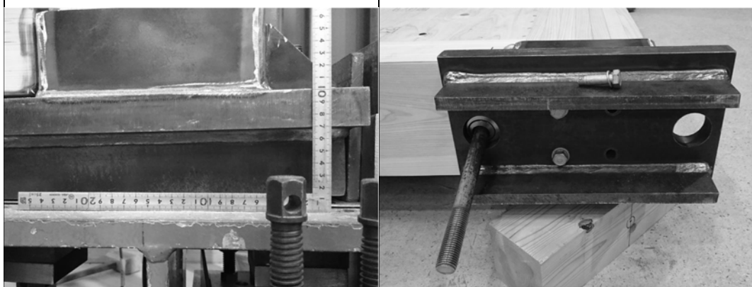
写真 2.4.10 PW-3-1 柱脚浮き上がり
