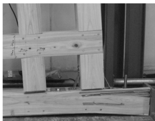
写真 3.3.6 KH-1 引張側柱脚 加力後
