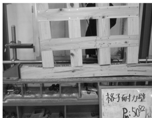
写真 3.3.4 KH-1 壁脚 加力後
