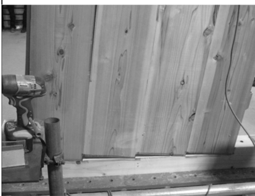
写真 3.2.35 MH-1 壁脚(背面) 加力後
