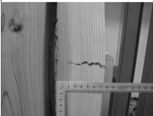
写真 3.2.44 MH-2 柱割裂破壊
