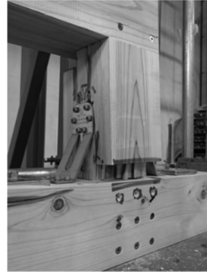
写真 3.3.24 KS-2 引張側柱脚
