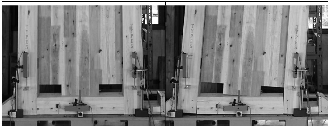
写真 2.3.42 CW-5-1 壁脚 加力前
