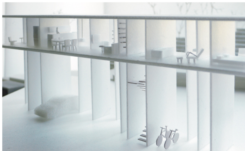
図 4-22 地面から立ち上がり、室内の間仕切りになる壁柱 (c) TNA
