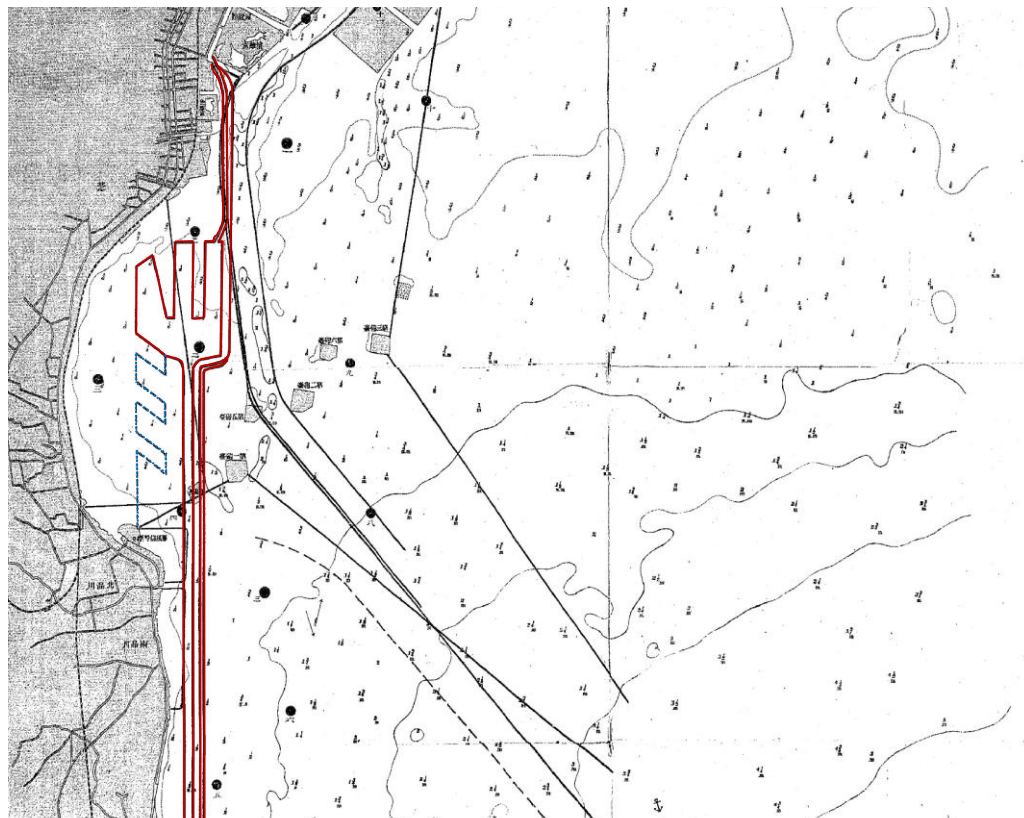
図 14 ルノーの築港設計意見案（赤線）。（出典：同前掲図面。一部著者加筆。）
