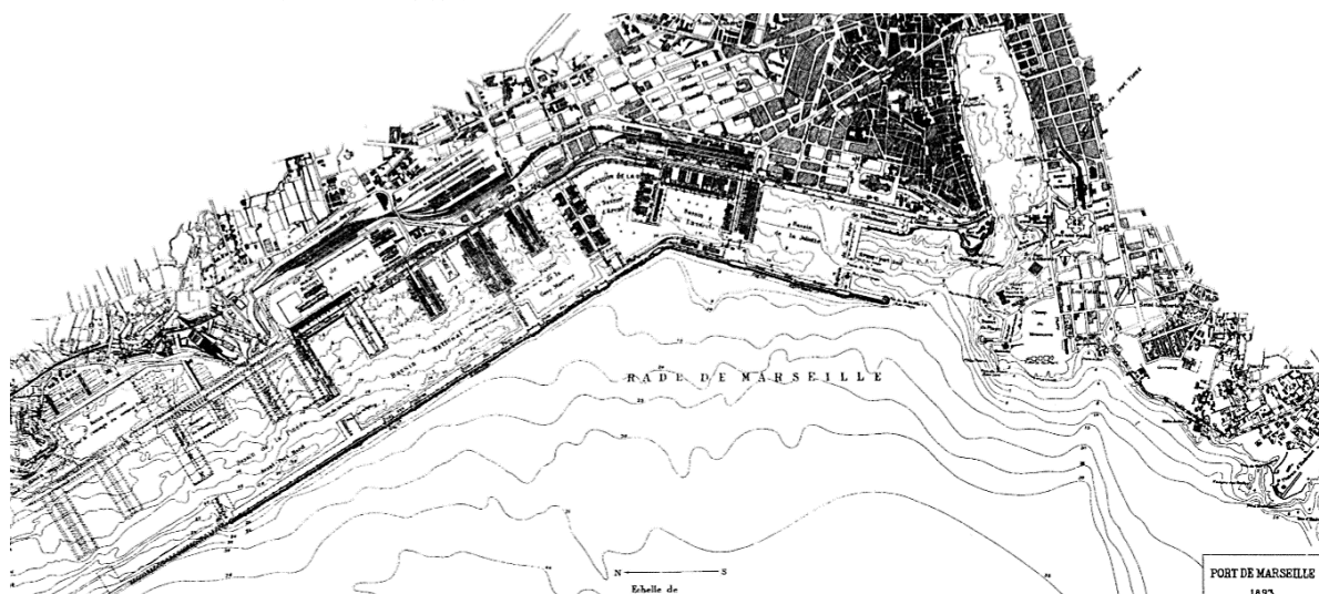
図 11 1893 年の時のマルセイユ港の拡張工事計画図。(出典：丹羽鋤彦「論説及報告：馬耳塞港(承前)」『工学会誌』第 247 巻、1902 年 12 月。)
