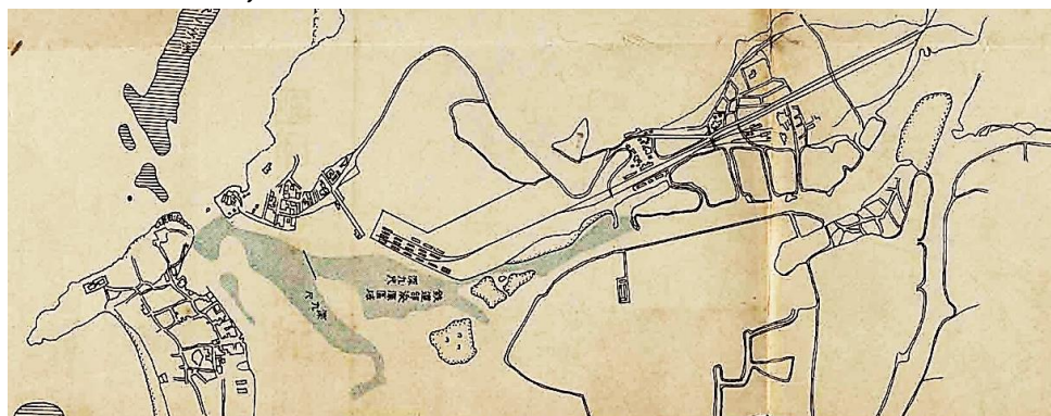
図20 打狗停車場敷地の拡張埋立工事が完成した後、鉄道線路が先端部の倉庫が並んでいる岸壁埠頭に延伸できるため、鉄道による海陸連絡ターミナルが初歩に形成された。(出典：「築港着手前の高雄港平面図」『大正八年度調 高雄築港概要』、1921年)
