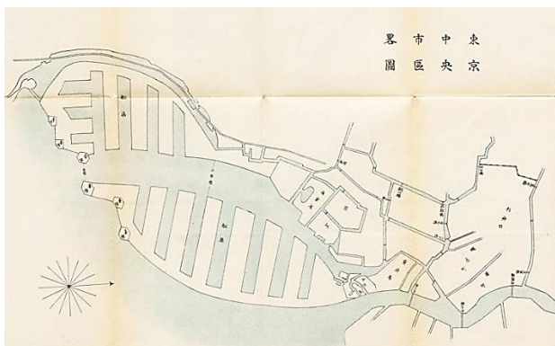
図5 のちの明治13年に提出された東京市区改正計画にそのまま転用された、肥田浜五郎に設計された隅田川河口から品川沖の間に埋立による13の船渠を設ける築港マスタープラン。（出典：『東京市史稿・港湾編3』、1926年）
