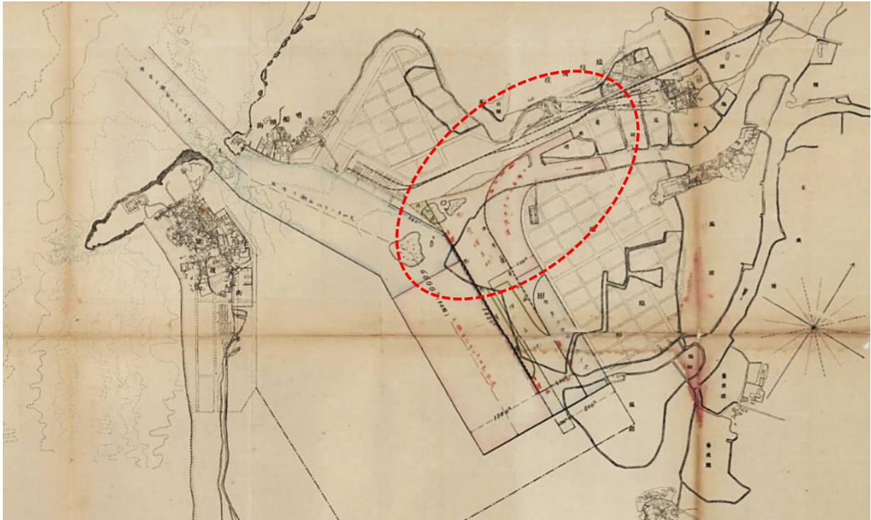
図 32 第一、第二岸壁を連結させる連続的な海陸連絡埠頭を建設するため、本来の船舶と停車場との間に舢舨による接続輸送に重要な役割を担う水路運河を断ち切ったゆえ、岸壁の造成工事を行うと同時に、改めて第二岸壁の後ろに新たに停車場前の船溜と連絡できる運河水路を開削したことが見える。(出典：『打狗築港』1910年)
