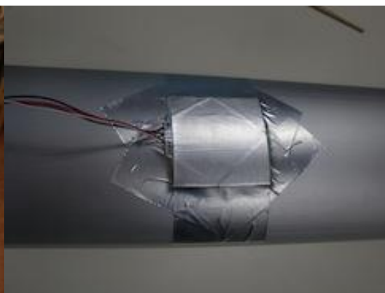
写真 6.11 熱流計の添付状況
