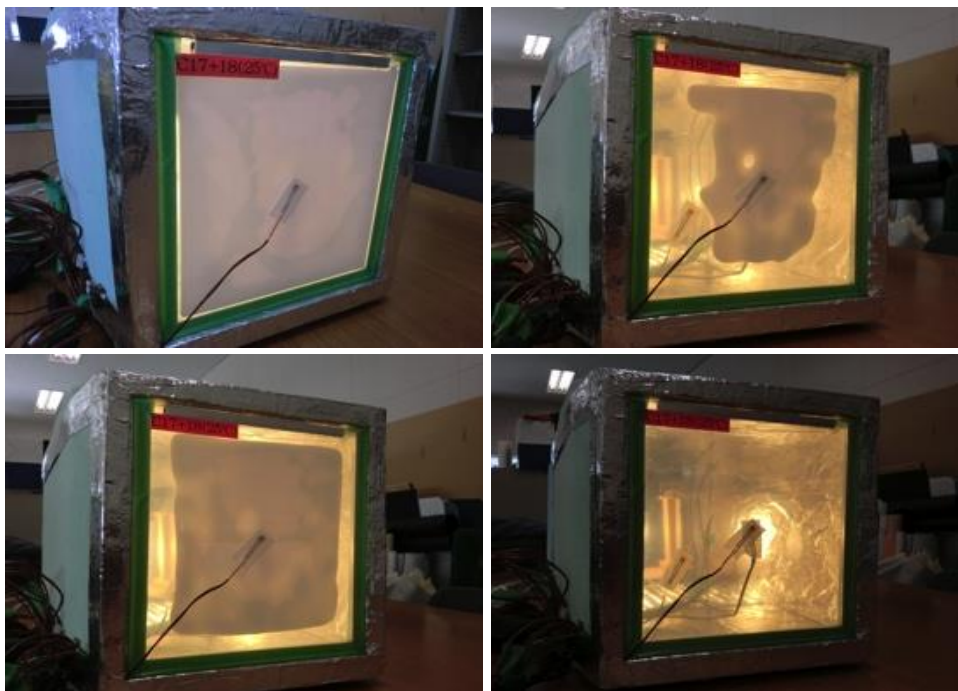
写真 6.5 日射透過率試験装置 (A 室昇温時)
