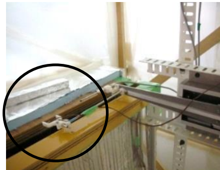
写真 6.14 トラバース装置とセンサ
