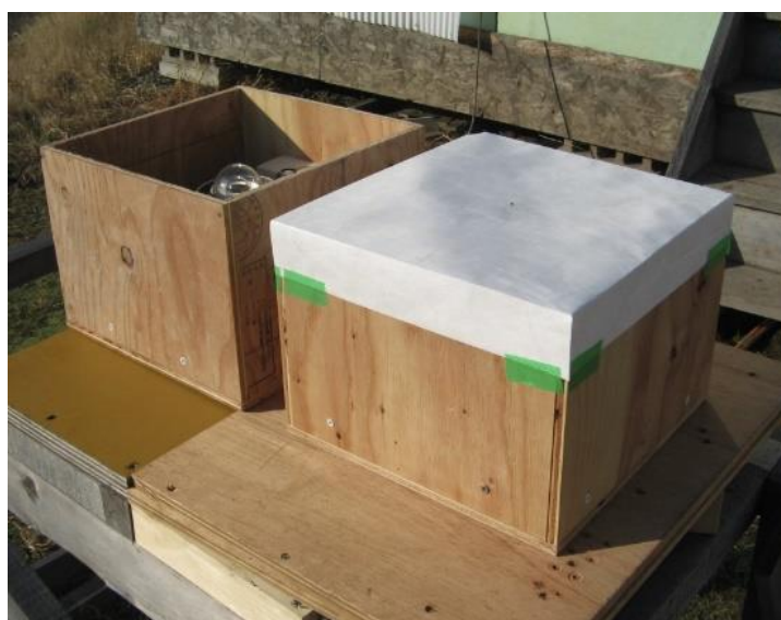
写真 4.1 日射遮蔽試験装置
