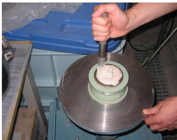
写真 2.8 スランプ試験の様子①
