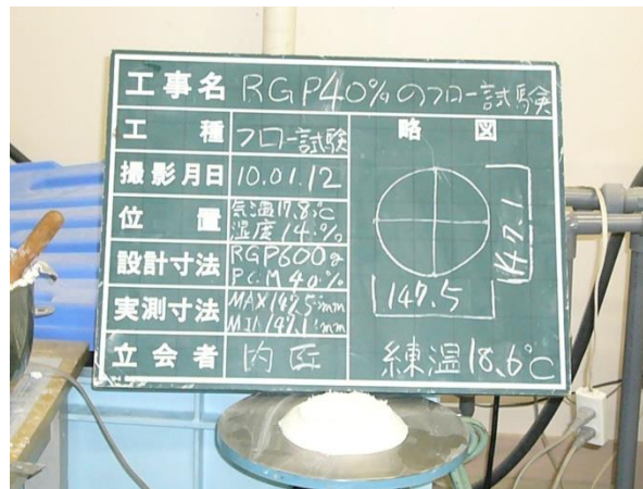
写真 2.9 スランプ試験の様子②
