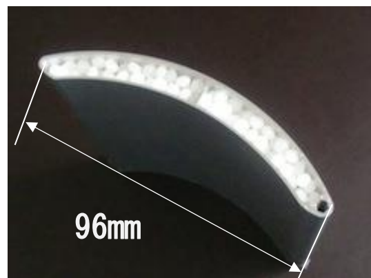
写真 6.9 粒状 PCM の充填
