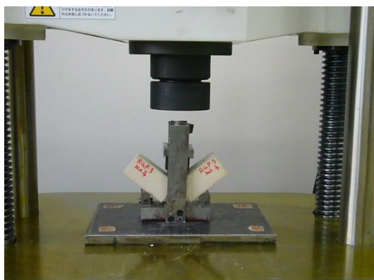
写真 2.6 曲げ強度試験
