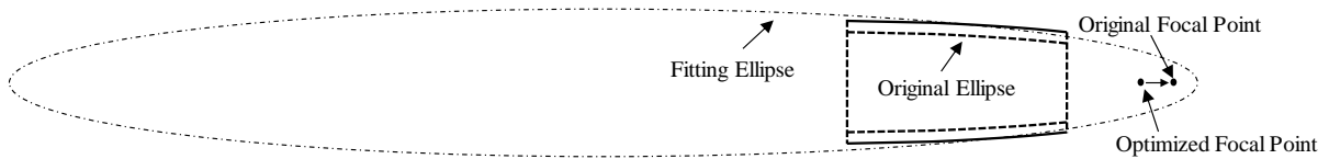
図 2.9 楕円フィッティング操作の概念図．破線が直径誤差のない( \delta=0 )の場合のミラーのプロファイル，実線が直径誤差の存在する( \delta>0 )場合のミラーのプロファイル，1点破線が \delta \neq 0 の場合のミラープロファイルにフィッティングした楕円関数を示す．波動光学シミュレーションでは，フィッティングした楕円の2焦点を光源点と集光点とする．
