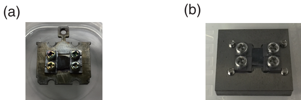
図 3.14 実験に使用したアナターゼ型二酸化チタンの天然結晶．(a) の試料の色は均一でなく，部分的にオレンジと青色を呈しているが，向こう側が透けて見える程度に透明である．それに対して (b) は黒色を呈している．(b) の試料には XPS の測定で Fe が検出された．
