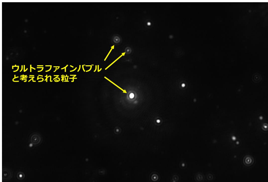
図 6.13 ナノサイトによって撮影された 11 日後の溶解サンプル内粒子の様子
