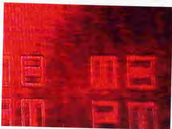
図 5.10: ガラスモールドとフォトレジストとが片当たりしている部分の CCD カメラ像 (約 800\ \mu\text{m} \times 500\ \mu\text{m} )
