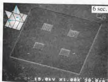
図 4.40: レジストパターンのSEM像 (モールドの段差: 200 nm)
