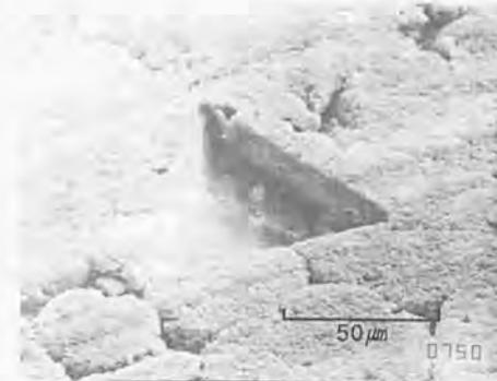
深さ： $35\mu\text{m}$       工具材料：超硬合金      加工荷重： $4.9 - 9.8\text{ mN}$
