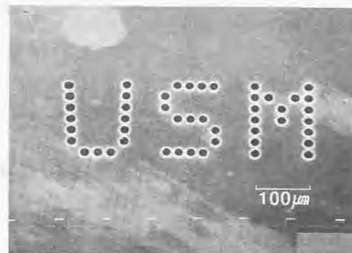
加工穴径：22 $\mu\text{m}$       深さ：10 $\mu\text{m}$       工具材料：ダイヤモンド焼結体
