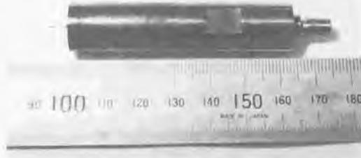
図3.9 工具材料を取り付けたホーン
