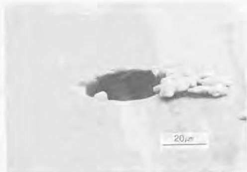
深さ：120 $\mu\text{m}$       工具材料：超硬合金      工具回転数：200 rpm
