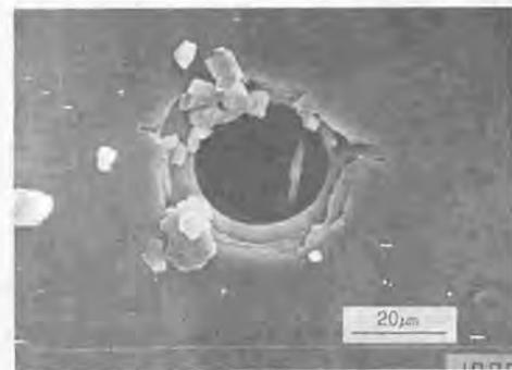
(b) 出口側 加工穴径：27 μm
