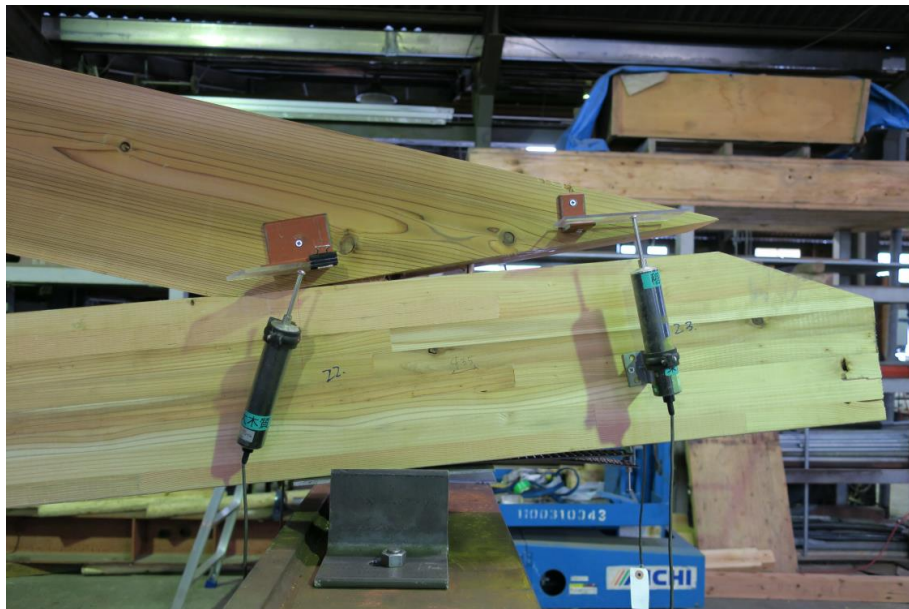
图 4- hEWT_12s-3 試験体 合掌尻 陸梁破壊時
