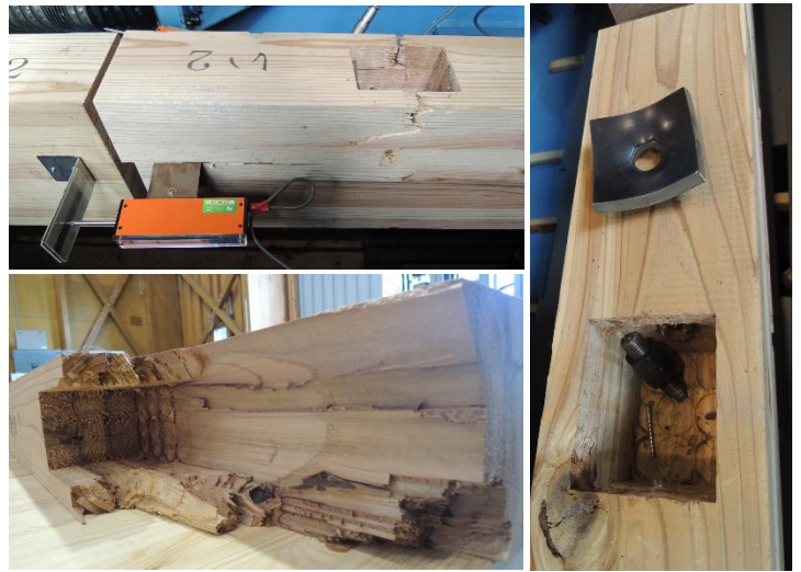
図 2-1 No. 18 試験体 主な最終破壊状況写真
