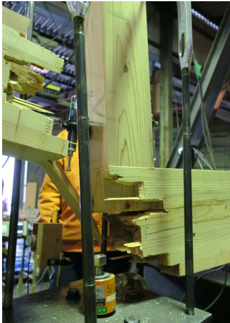
図 4- hEWT_12s-3 試験体 最終破壊状況_側束下の陸梁の曲げ引張破壊
