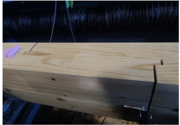
図 2-1 0J-SWJ×10 試験体 主な最終破壊状況写真
