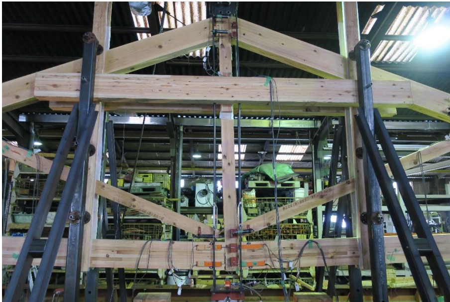
図 4- hEWT_12s-2 試験体 最終破壊状況_真束付近
