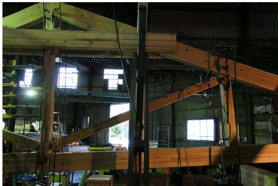
図 4- hEWT_12s-3 試験体 最終破壊状況_側束下の陸梁の曲げ引張破壊
