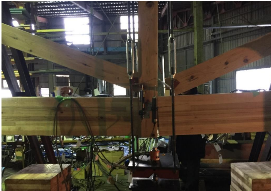
図 4- hEWT_12s-2 試験体 最終破壊状況_真束を挟む陸梁継手の開きと斜材のホゾの抜け
