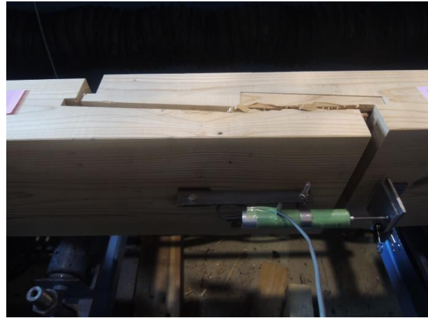
図 2-1 OJ-CL 試験体 主な最終破壊状況写真
