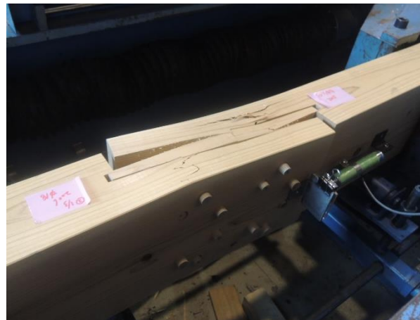
図 2-1 OJ-WPJ 試験体 主な最終破壊状況写真
