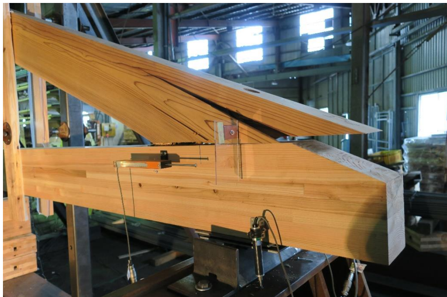
図 4- hEWT_12s-2 試験体 最終破壊状況_合掌尻のすべりと割裂破壊
