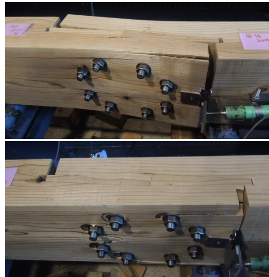
図 2-1 OJ-BTJ 試験体 主な最終破壊状況写真
