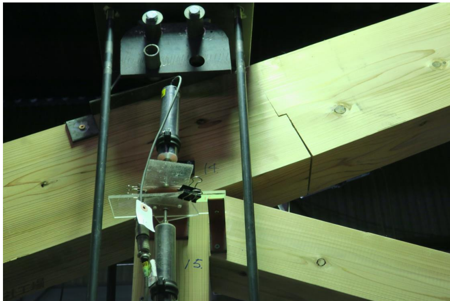
図 4- hEWT_12s-3 試験体 登り梁継手の下端の開き
