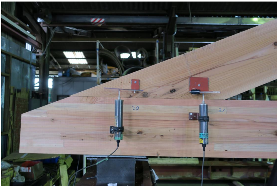
图 4- hEWT_12s-3 試験体 合掌尻 割裂発生時
