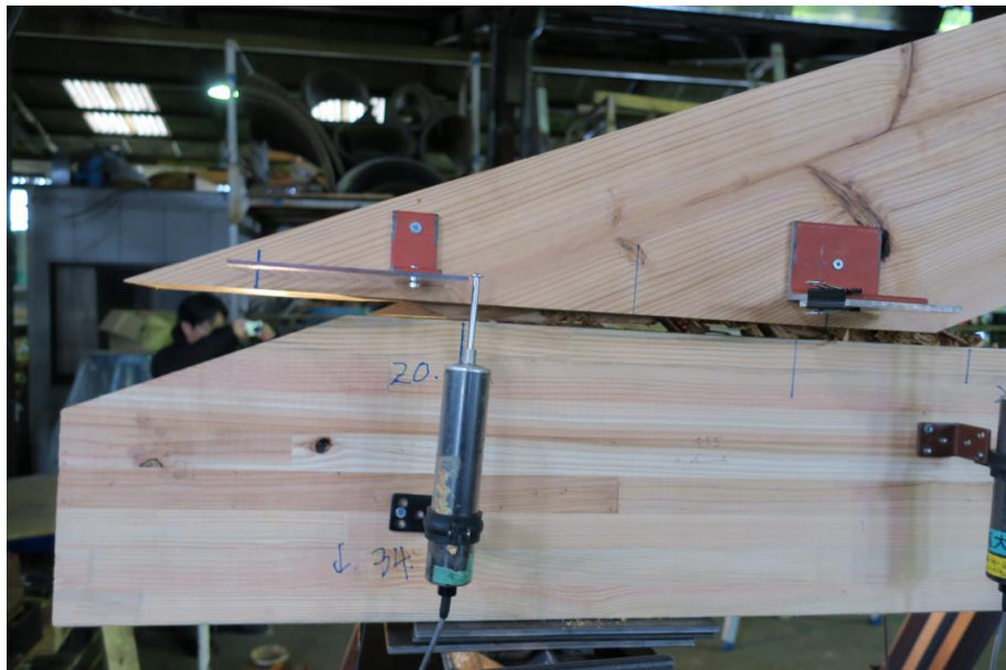
図 4- hEWT_12s-2 試験体 最終破壊状況_合掌尻のすべり
