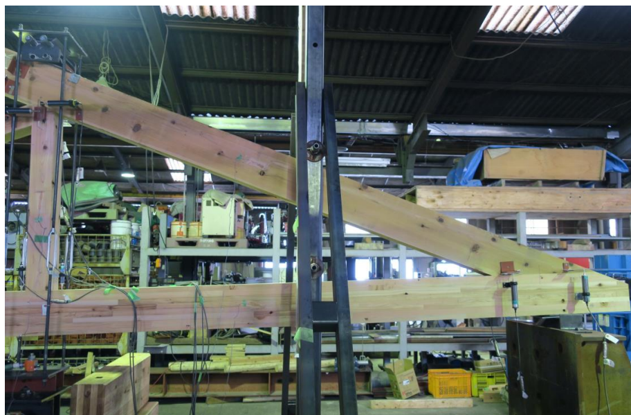
図 4- hEWT_12s-2 試験体 最終破壊状況_合掌尻
