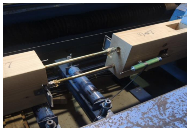
図 2-1 No. 10 試験体 主な最終破壊状況写真
