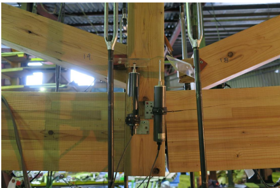
図 4- hEWT_12s-2 試験体 最終破壊状況_真束下の陸梁継手の開きとホゾの抜け出し
