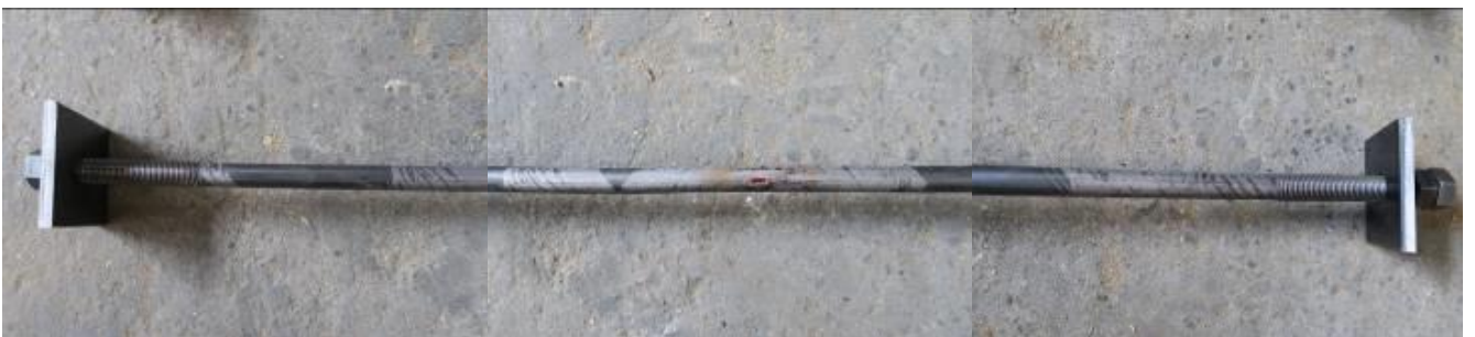
図 5- 陸梁継手の試験終了後の引きボルトの伸びの状況
