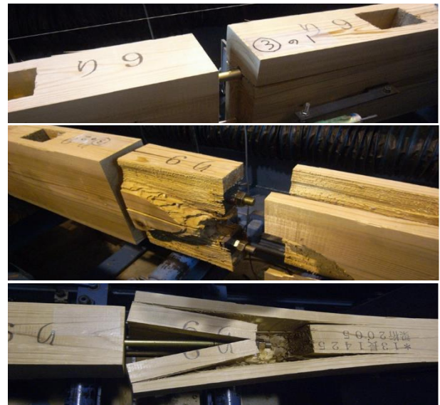
図 2-1 No. 14 試験体 主な最終破壊状況写真
