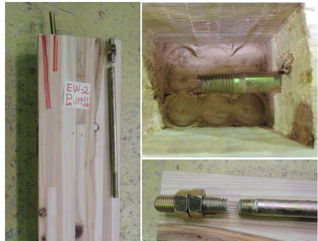
図 2-1 No. 16 試験体 主な最終破壊状況写真
