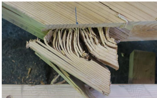
図4- EWT_9s 試験体 合掌尻登り梁下端部の三角ホゾの始端部の屈曲
