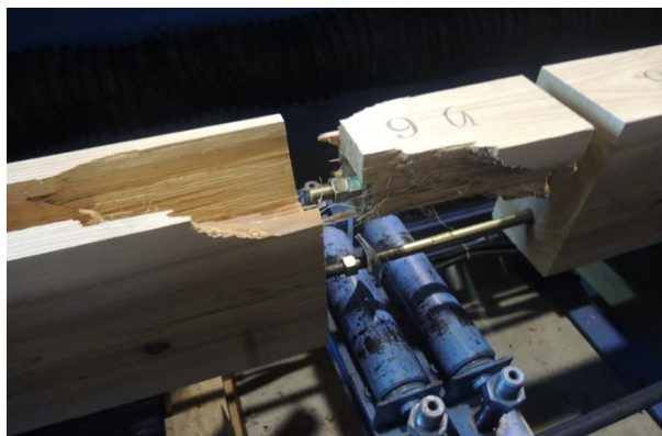
図 2-1 No. 8 試験体 主な最終破壊状況写真
