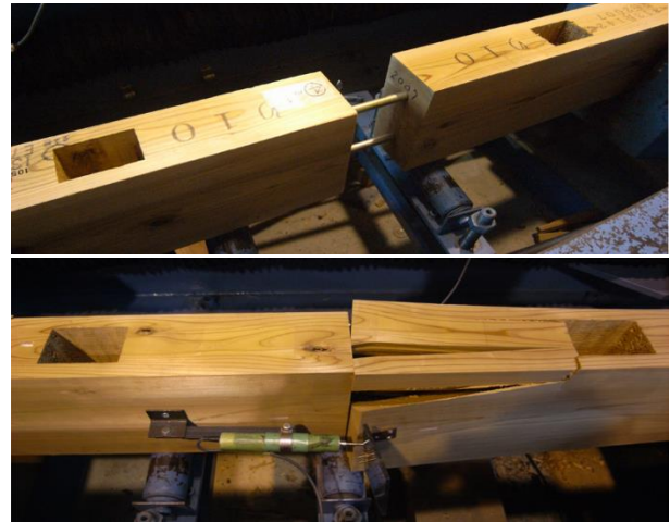
図 2-1 No. 15 試験体 主な最終破壊状況写真
