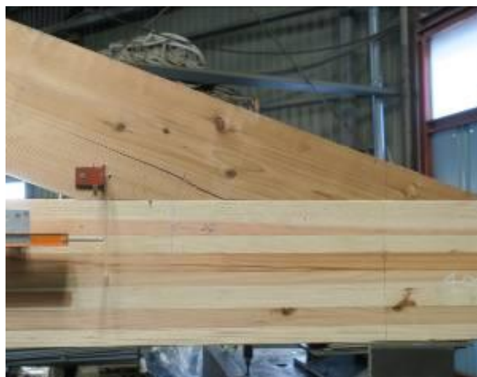
図5- 合掌尻仕口のすべりと割裂
