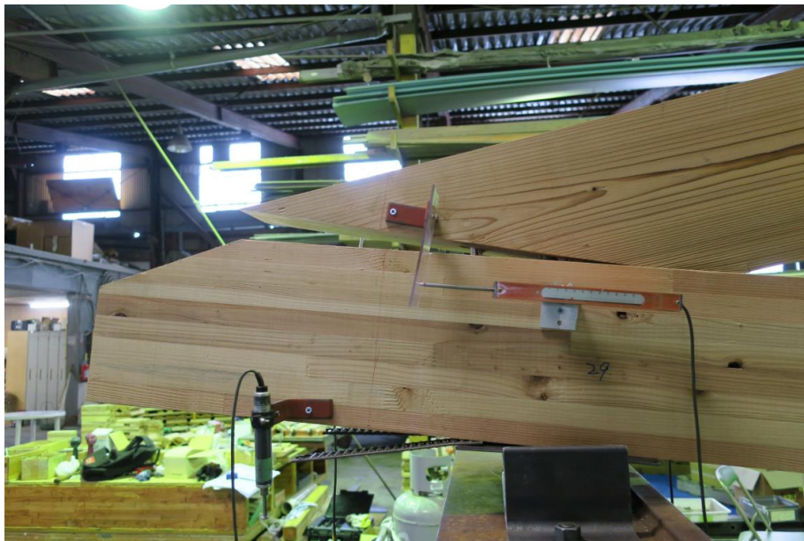
图 4- hEWT_12s-3 試驗体 合掌尻 陸梁破壊時
