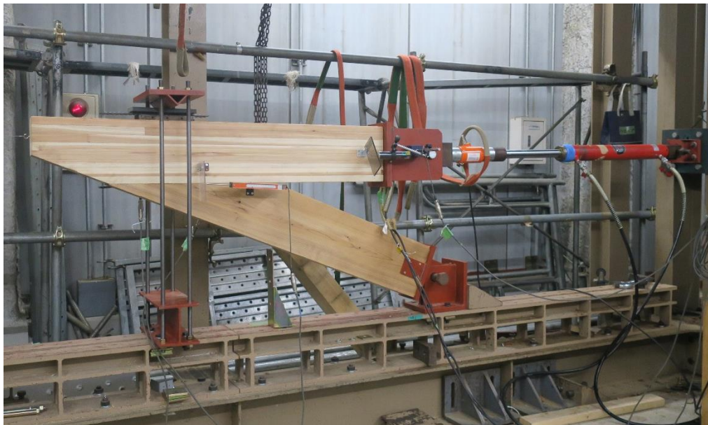
図 6- 合掌尻仕口 実験装置及び試験体略図
