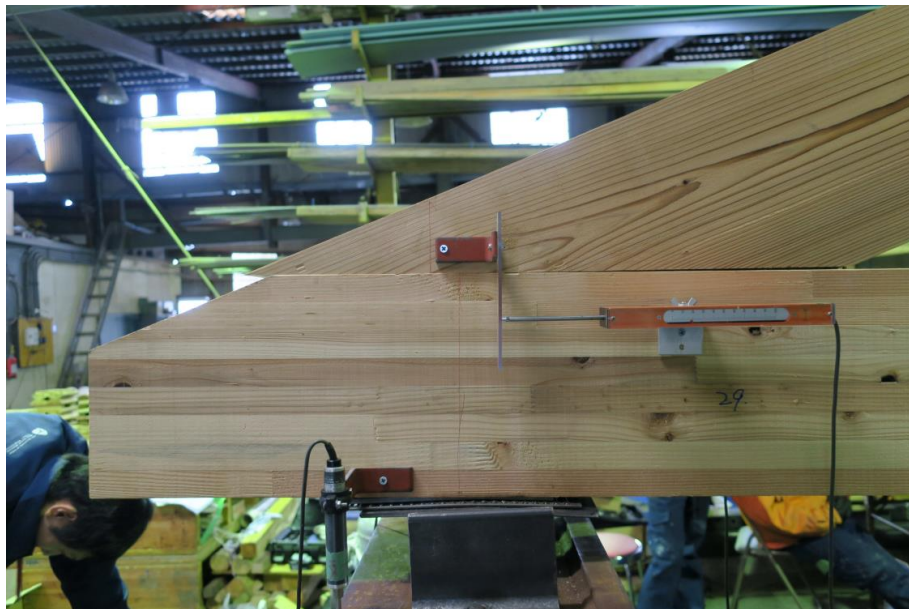
图 4- hEWT_12s-3 試驗体 合掌尻 加力開始直後
