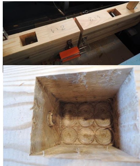
図 2-1 No. 23 試験体 主な最終破壊状況写真
