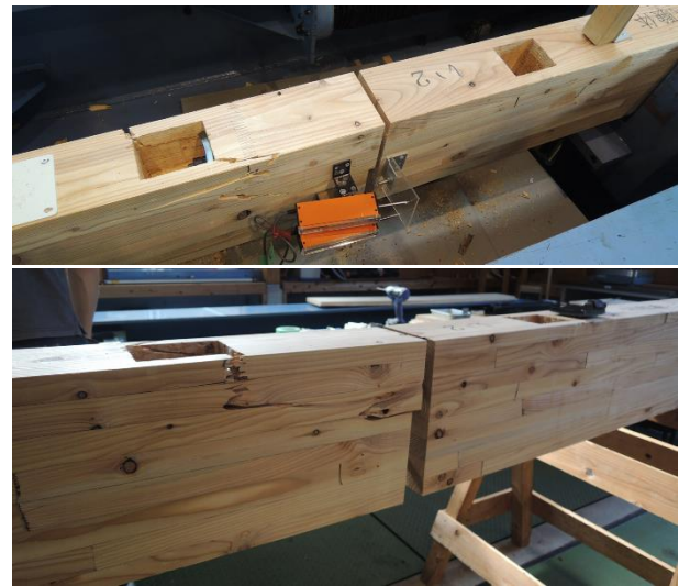
図 2-1 No. 19 試験体 主な最終破壊状況写真
