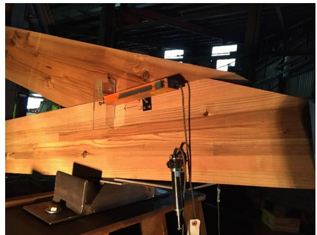
図 4- hEWT_12s-2 試験体 最終破壊状況_合掌尻のすべり
