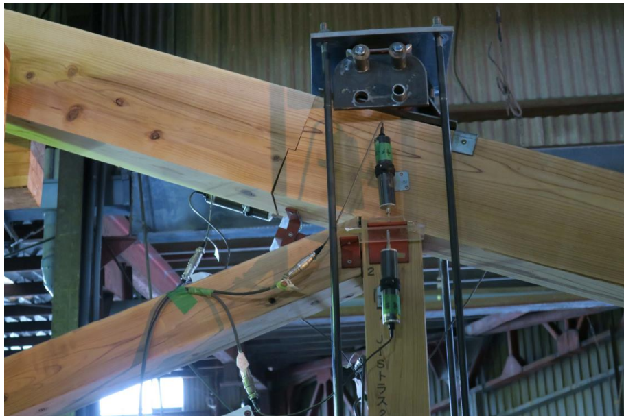
図 4- hEWT_12s-2 試験体 最終破壊状況__登り梁継手の下側の開き
