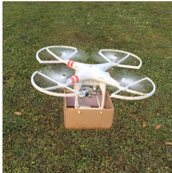
図 4.15: マルチコプタへの貨物の積載方法. 脚部に重量 100 g のカゴを取り付け, その中に 200 g または 400 g の重りを配置した.
