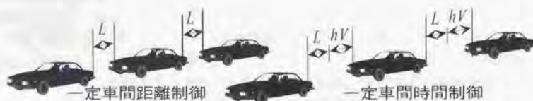
図2.2.3 一定車間距離制御と一定車間時間制御
