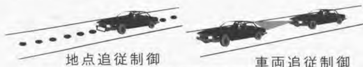
図2.4.1 地点追従制御と車両追従制御
