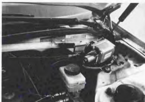
図 4.5.4 スロットルアクチュエータ
