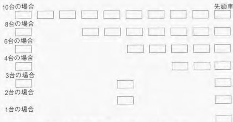
図10.5.2 構成車両台数によってプラトーン長が変化せず、 先頭車周辺の車間距離を小さくしたプラトーン形態
