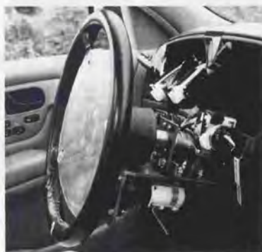
図8.5.3 ステアリングアクチュエータ
