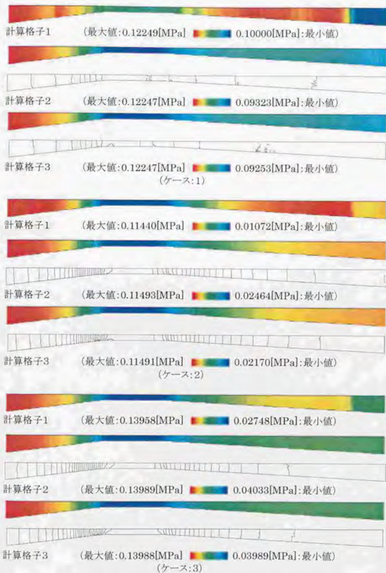
図(5. 3b) 計算格子間隔に対する静圧分布(図は中心面, 等高線間隔は 3333[Pa])
