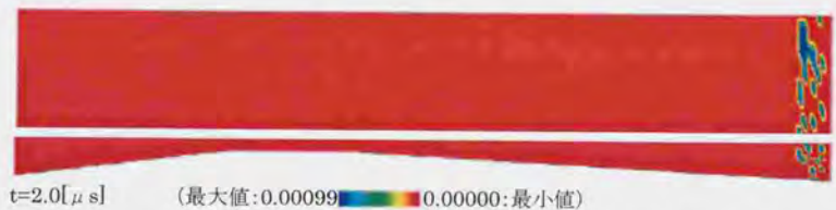
図(5.23a)断熱壁条件での気泡発生過程のボイド率(上面図・側面図ともに中心面)
