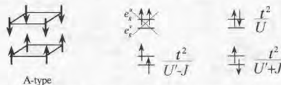
Fig. 2.1.1 x=0 の母体物質で観測される磁気秩序と、これを説明する2-バンド系の超交換相互作用。右側に記されたような4種類の仮想中間状態を経由する2次摂動のエネルギー利得の比較が、その骨子となっている。§4.1参照。
