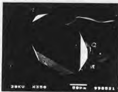
図 2.1: \text{LiV}_2\text{O}_4 単結晶の一例。(111)面が成長している。
