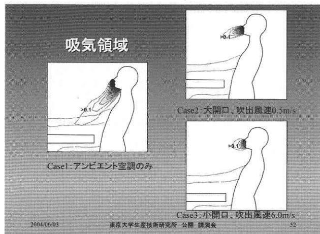
この図は、呼吸による吸入空気の種類を示します。空気清浄機がない場合、机面側にその領域が伸び、この場所に汚染発生があるとこれを吸引してしまう可能性が示唆されますが、空気清浄機がある場合、吸入空気の範囲は清浄空気の吹出気流範囲に接しており、この面では、汚染質を吸入する可能性が減少しています。
