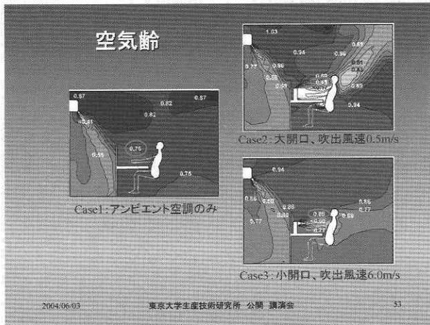
この図に示す空気齢は、給気口から室内に吹出された空気がその点に届くまでの時間を表しています。値が小さいのは、吹出口からあまり時間を経ずして空気がその点に到着することを示し、その分、その空気が汚染される可能性が小さいことを示します。ここで空気清浄機の吹出しが大開口の場合と、小開口でどのように違うかということが問題になります。大開口の場合は、人体の呼吸吸入領域の空気が若く、汚染の可能性が少ない良い環境であることを示します。一方、小開口の場合は、清浄機から吹出された空気は周辺空気と混合が進んでしまい、人体に達する時にはその空気齢も年取ってしまっている。
