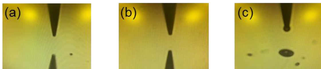
図 3-2 ODCB と MeCN を(a)10:1、(b)7:1、(c)5:1 で混合したときの吐出の様子
