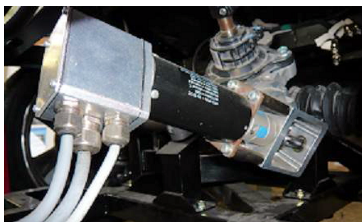
Fig. 11: EPS 用モータ
