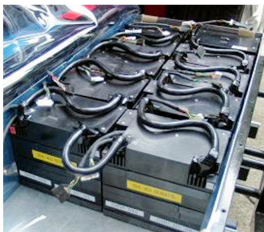
Fig. 13: FPEV2-Kanon のリチウムイオン電池
