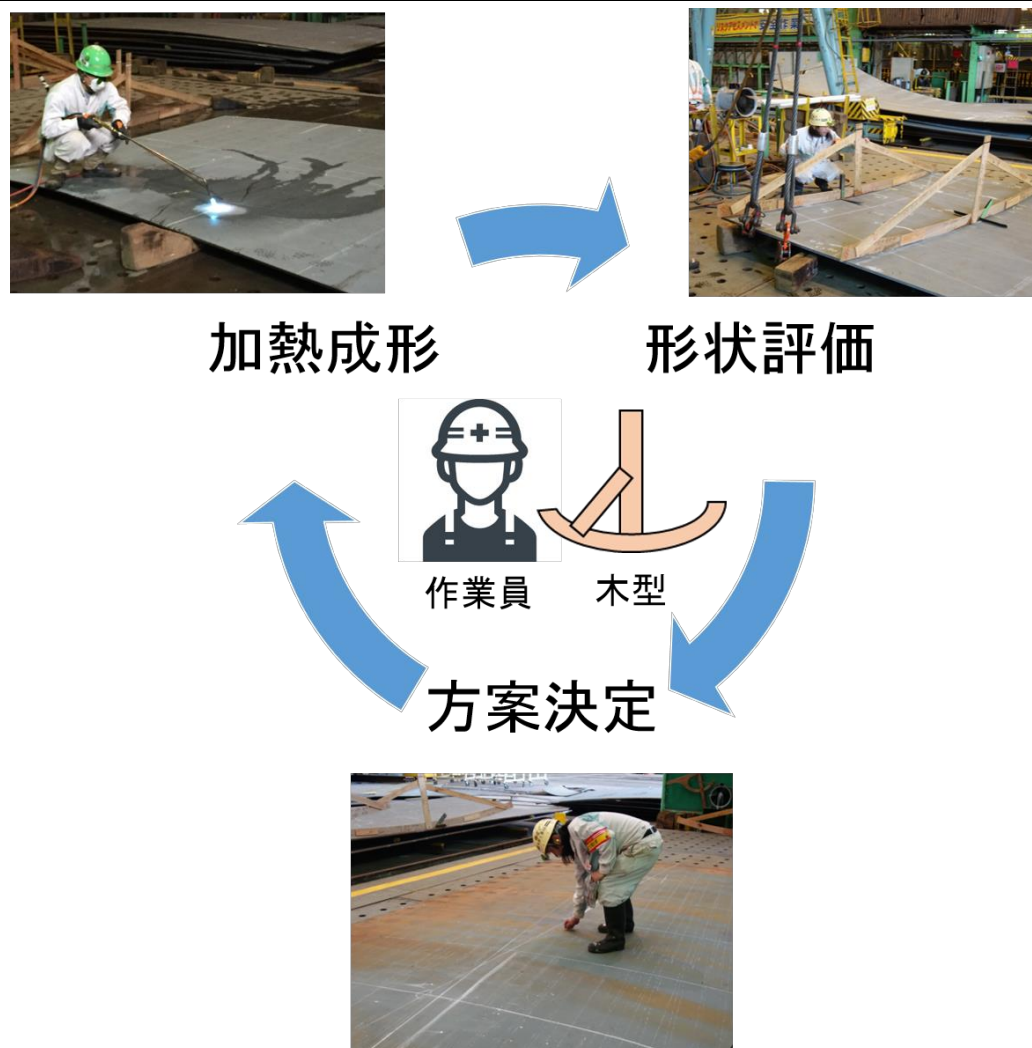
図 1-2 ぎょう鉄の加工工程の繰り返しフロー
