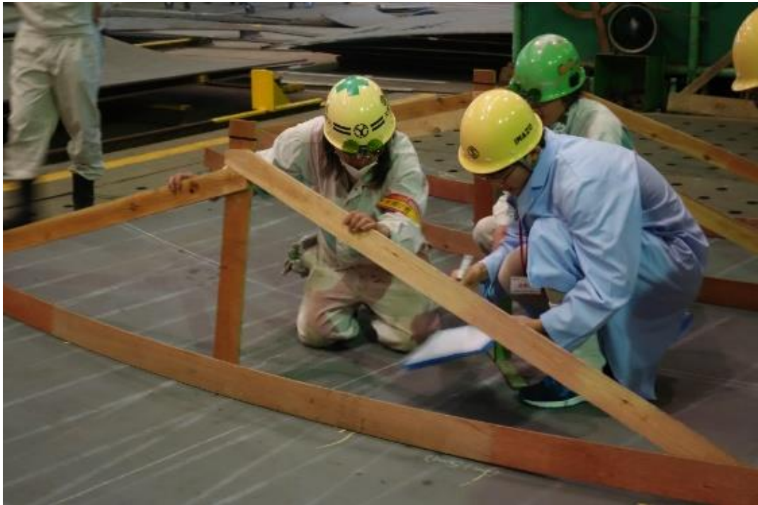
図 7-14 作業員によるフレーム線の形状評価の様子
