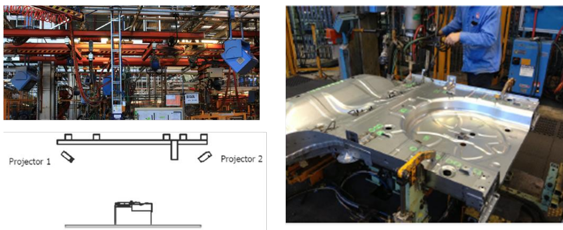
図 2-11 システムの構成（左）と作業指示のデモンストレーション（右） [26]
