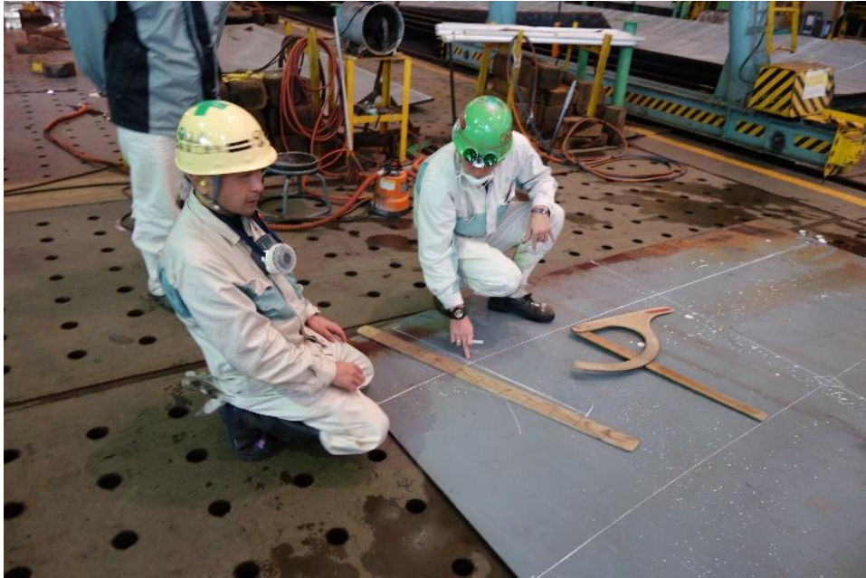
図 7-18 巻き尺と分度器を用いた加熱線のマーキングの様子
