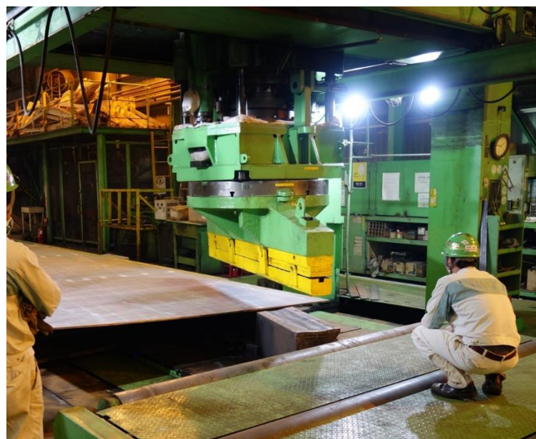
図 9-1 プレス機によるプレスの様子
