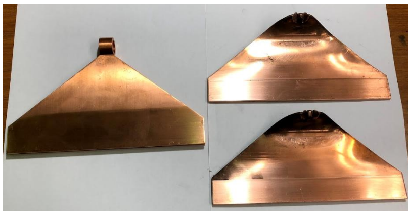
図 4-4 磁場発生前後の一巻きコイルの写真（左：実験前、右：実験後）
