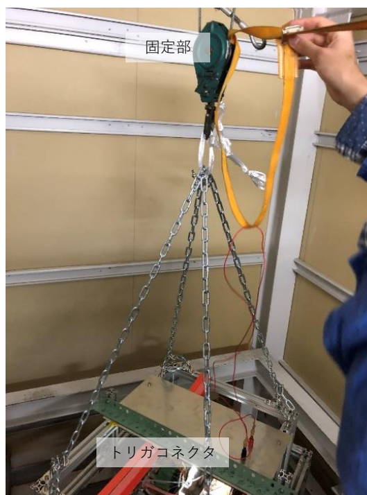
図 3-32 トリガーコネクタ（バナナプラグ）と固定部分
