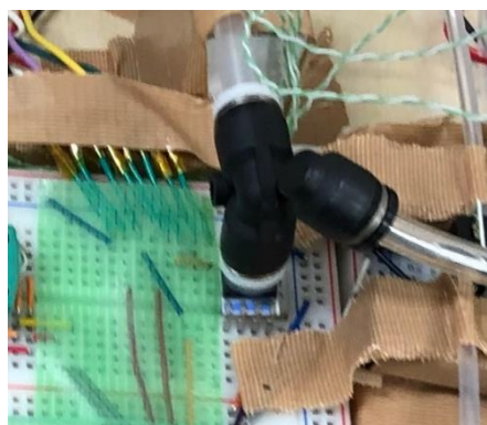
図 3-28 排気タンク圧力計 Honeywell 社製 (model: HSCDANT2.5BAAA5)
