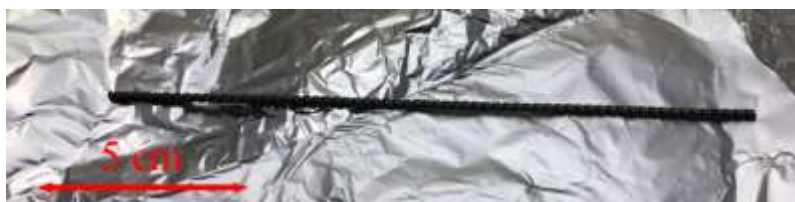
図 3.1. Ti フィラメント。直径約 0.8mm、長さ約 157 mm のタングステン製の棒の周りに直径 0.82 mm のチタン線と直径約 0.4mm のモリブデン線を巻いた構造になっている。
