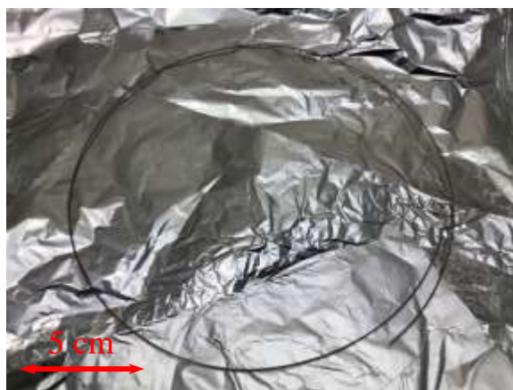
図 4.1. Pd フィラメント。束になったニラコ製のパラジウムの細線を 200 mm だけ切って蒸着源として用いる。
