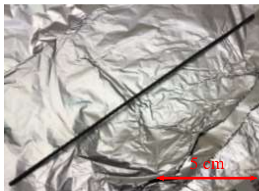
図 5.1. V フィラメント。V フィラメントは直径約 0.8mm、長さ約 157 mm のタングステン製の棒の周りに直径 0.5 mm のバナジウム線と直径約 0.4mm のモリブデン線を巻いた構造で、質量は約 2.57 g である。
