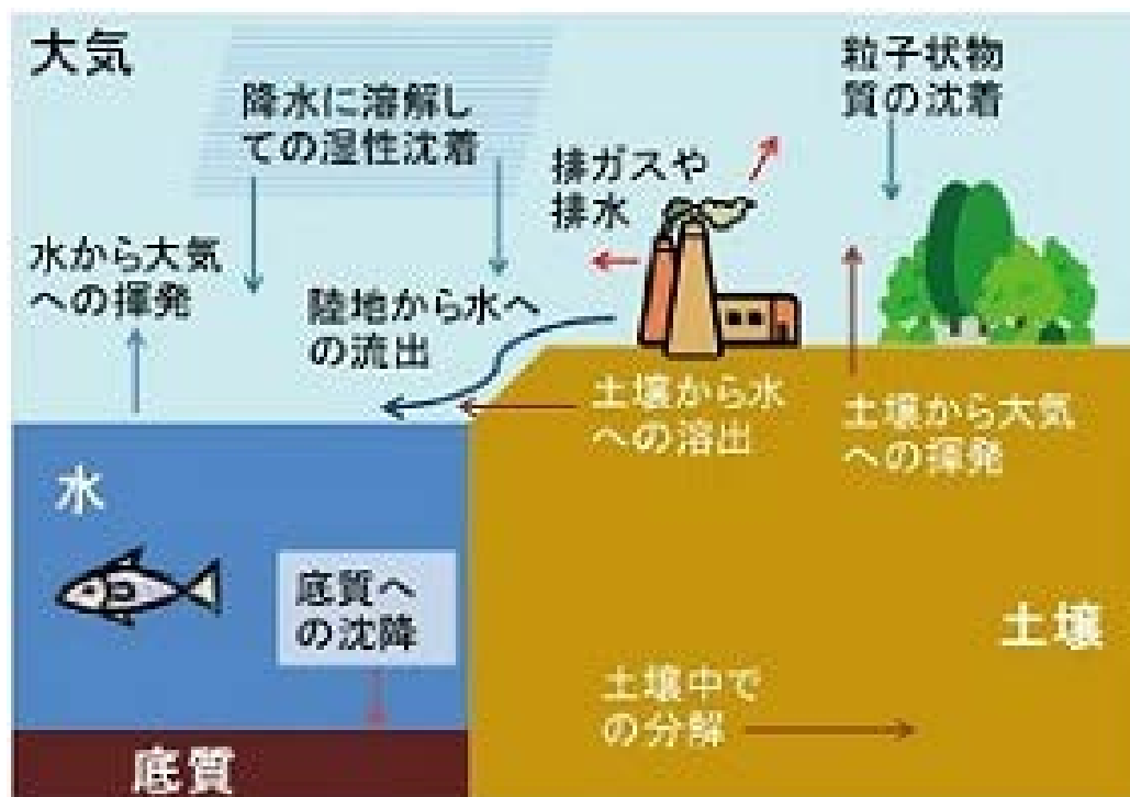
図 2-1 環境中における化学物質の動態・分配に関する模式図(国立環境研究所, 2013)
