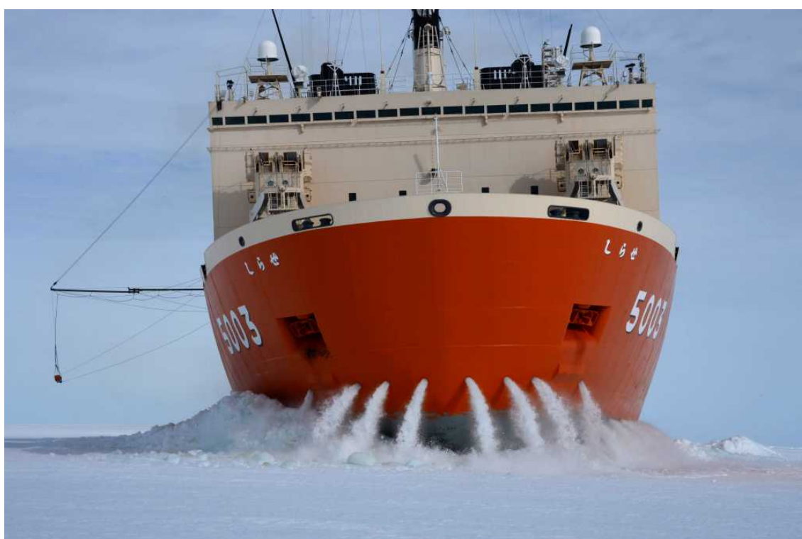
図 24 しらせの散水装置稼働中の様子 ([29]より引用)
