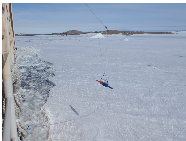
図 22 しらせ右舷側に張り出されて計測中の船上 EM センサー
