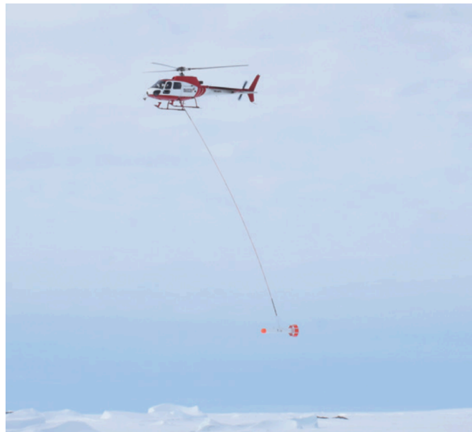
図 23 ヘリコプターに吊り下げられて計測中の EM-Bird ([26]より引用)
