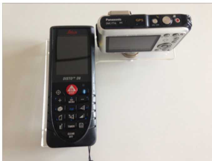
図 20 コンパクトカメラとレーザー距離計による観測装置
