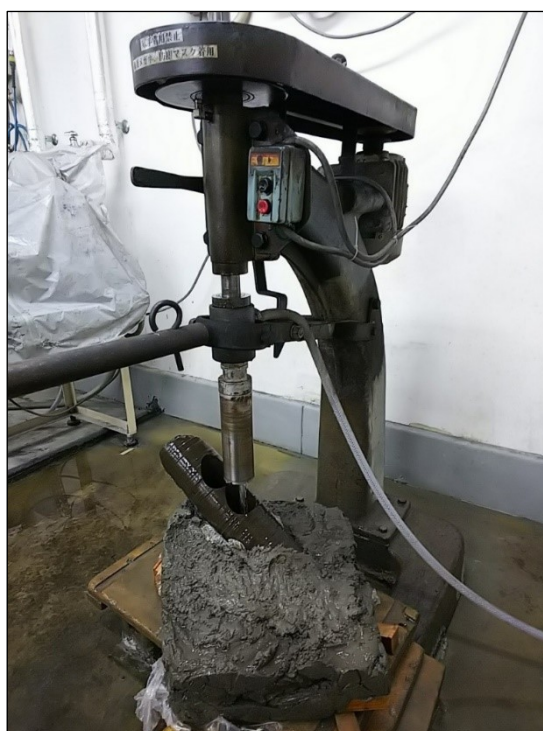
図 3-4 コア抜きに用いたボーリングマシンとモルタルで固定したボーリング試料
