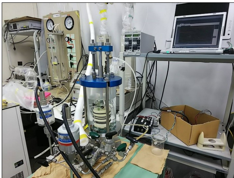
図 3-12 フローポンプ法による透水試験の様子
