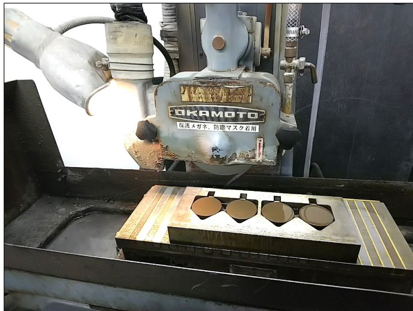
図 3-6 研磨に用いた平面研削盤と研磨の様子（幌延泥岩）
