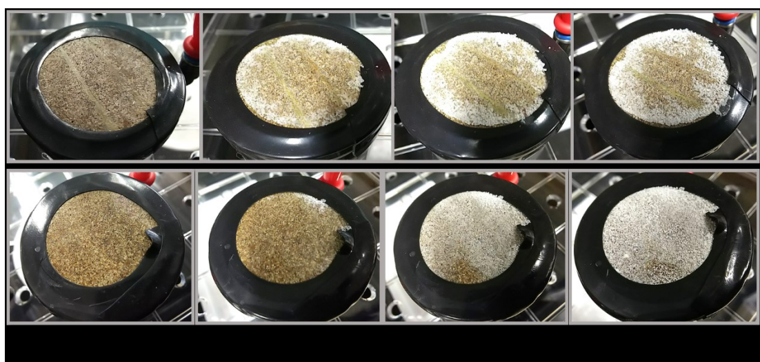
図 4-22 (多胡) 20 mm (上) および 30 mm (下) サンプルにおける塩析出の過程 (左は MgCl_2 をシャーベットから固相に交換時、数字はその時点からの経過時間)
