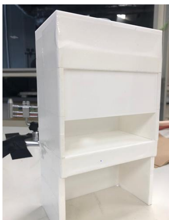
Fig.4-3 1/10 スケールサイズ (a) ヒュームフード (b) ルーバー
