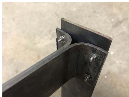
図 3.2.7 試験体 B 接合部 (梁側)
