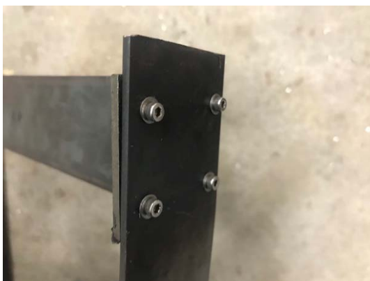
図 3.2.6 試験体 B 接合部 (柱側)
