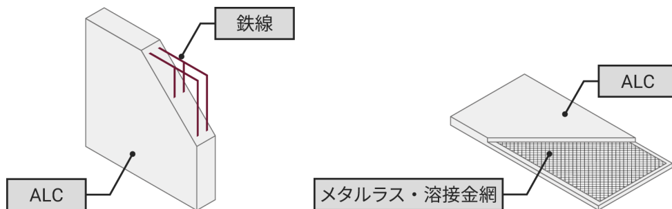
図 2-4 厚形 ALC パネル（左）と薄形 ALC パネル（右）
