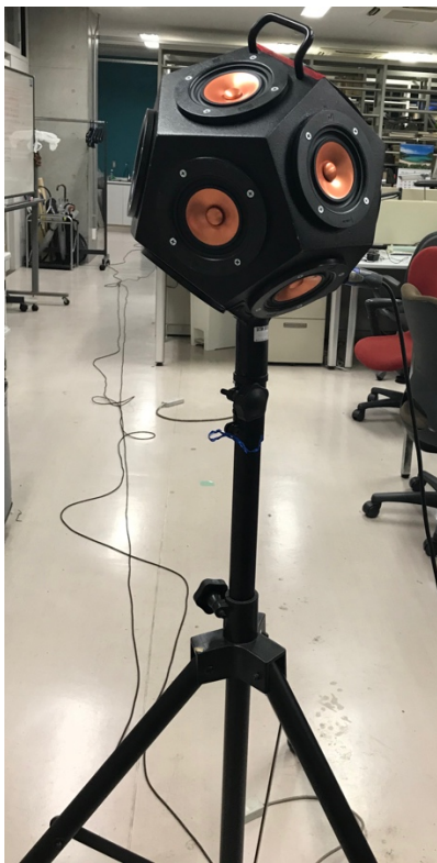
図 3-12 12面体スピーカ(Bruel &amp; Kjaer 4296) 図 3-13 精密騒音計(ONO SOKKI LA-5111)
