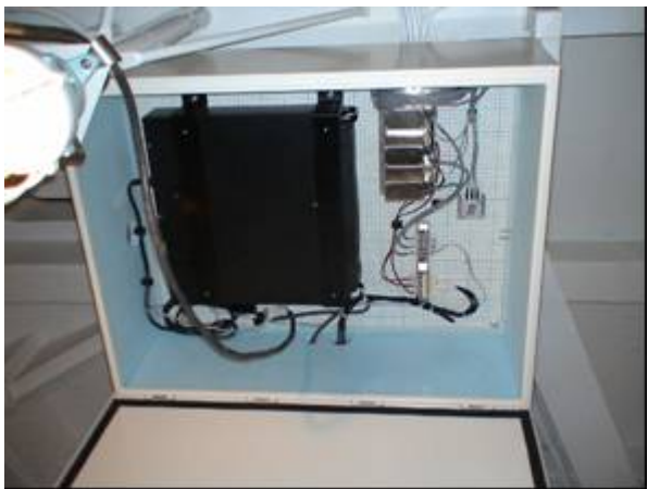
図 4-10 艦首 101 倉庫天井加速度計測ユニット ケース内部
