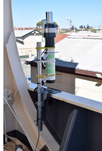
図 3-2 雨量計型飛沫計外観
