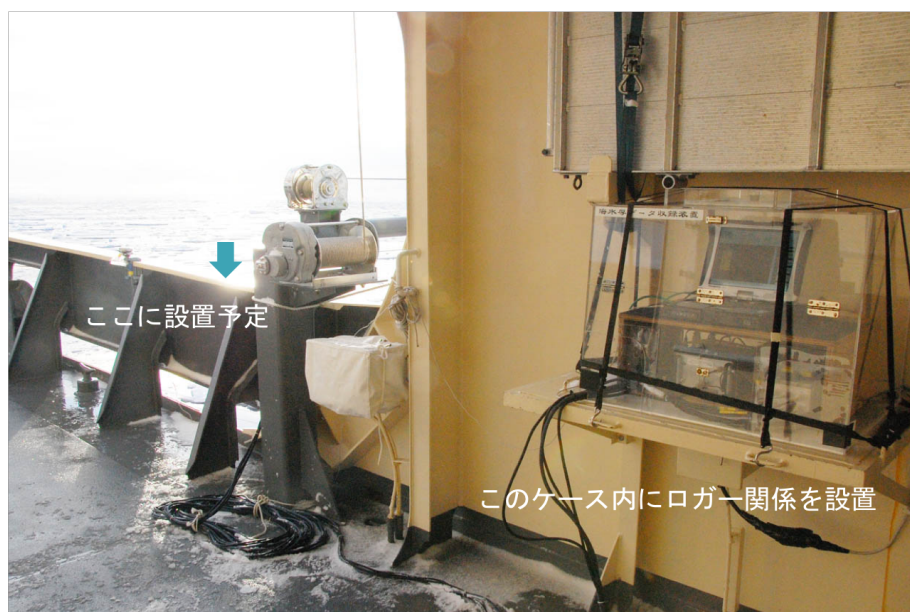
図 4-16 右舷雨量計型飛沫計設置位置
