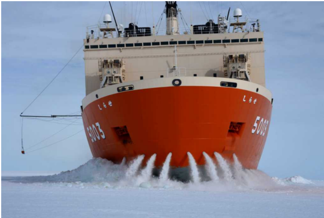
Fig. 1-6 「しらせ」の散水装置稼働中の様子（[3]より引用）
