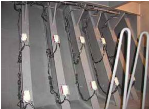
図 4-7 第 2 空所フレームせん断歪計測ゲージ
