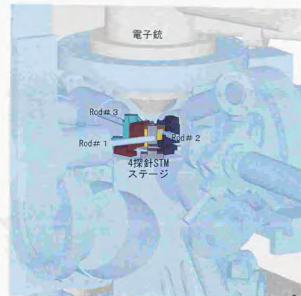
Fig4-10: メインチャンバーの内部構造 (ステージ周辺)
