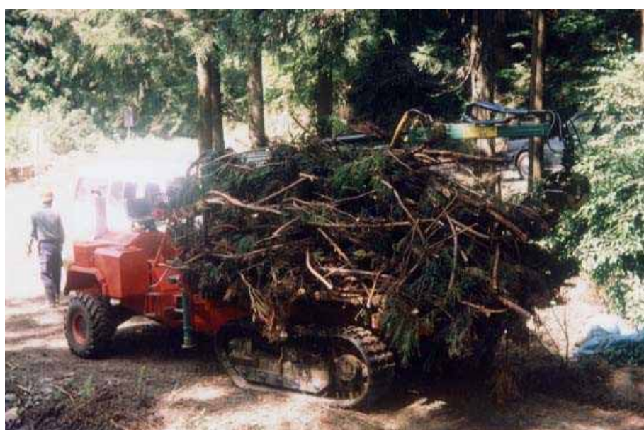
図-2.2 フォワーダによる森林バイオマス運搬実験
