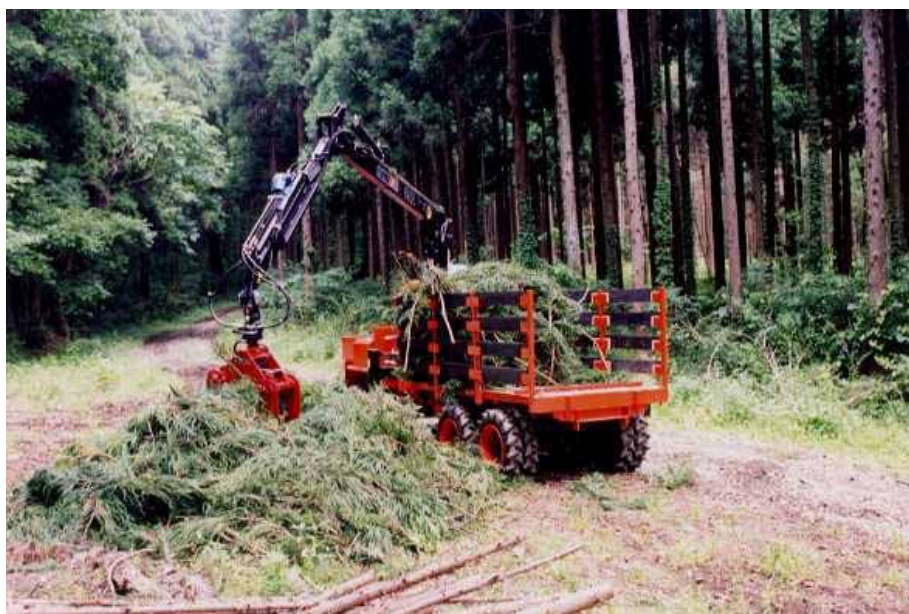
図-3.3 フォワーダによる森林バイオマス運搬実験
